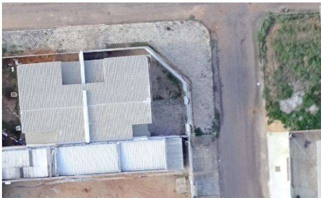
Figura 2. Detalhe em mosaico de calçada em intertravado.
