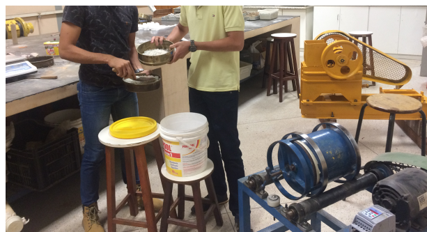
Figura 1. Processo de moagem do vidro laminado (AUTOR, 2021).
