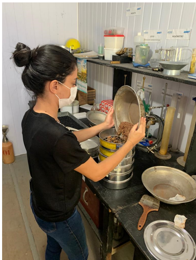
Figura 1. Peneiramento grosso. Fonte: Autoria Própria (2021).
