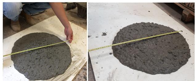
**Figura 6.** Flow test dos traços com 20% e traço com 40% de substituição. (AUTOR, 2021).
