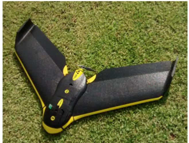
Figura 1. Veículo aéreo não tripulado modelo eBee.
