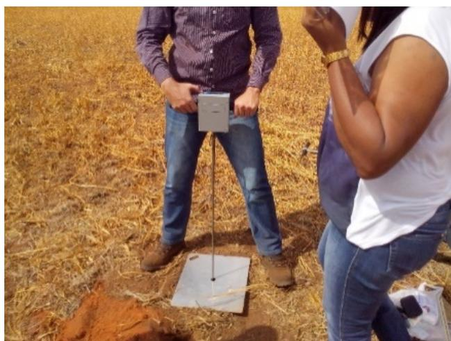
**Figura 2.** Mensuração da resistência à penetração das raízes no solo com o equipamento – Falker – PLG 1020.
