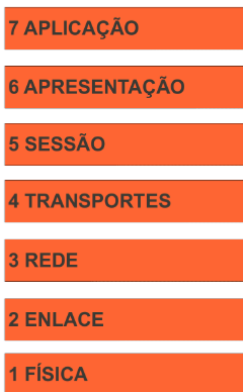
Figura 3: Camadas do modelo de referência OSI
