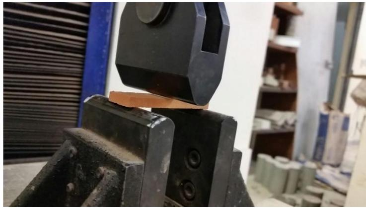
**Figura 14.** Corpo de Prova submetido a ensaio de Flexão em três pontos (Fonte: Autoria própria).
