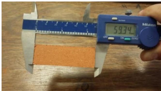
**Figura 12.** Medição do comprimento do C.P. para cálculo de Retração Linear (Fonte: Autoria própria).
