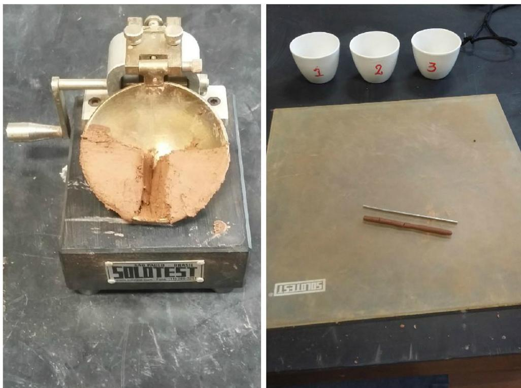
**Figura 9.** Ensaio: lado esquerdo Limite de Liquidez e; lado direito Limite de Plasticidade (Fonte: Autoria própria).
