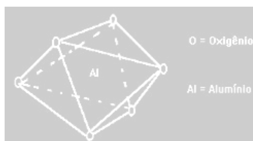
Figura 2: Estrutura química da argila silicatada de alumínio.
