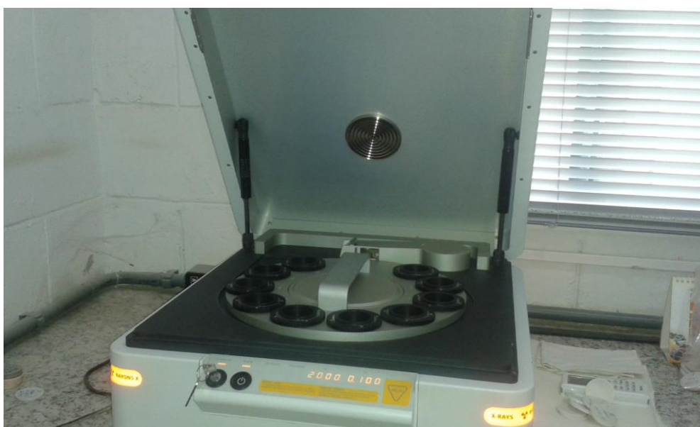
Figura 25 - Aparelho de Fluorescência de Raios-X, Modelo Epsilon 3, de propriedade da empresa J.D. Mito Mineração em que foram realizadas as análises.
