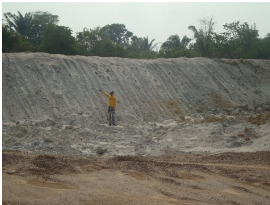
Figura 28 - Camada de estéril derivado de arenitos da Formação Piauí que aparece sobreposta a camada de Coberturas-Detrito-Lateríticas do Terciário-Quaternário (N3dl).
