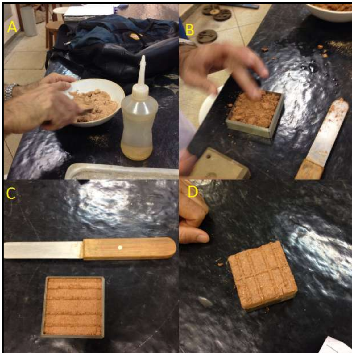
Figura 18 – Procedimentos da confecção do corpo de prova para ensaio de cisalhamento direto
