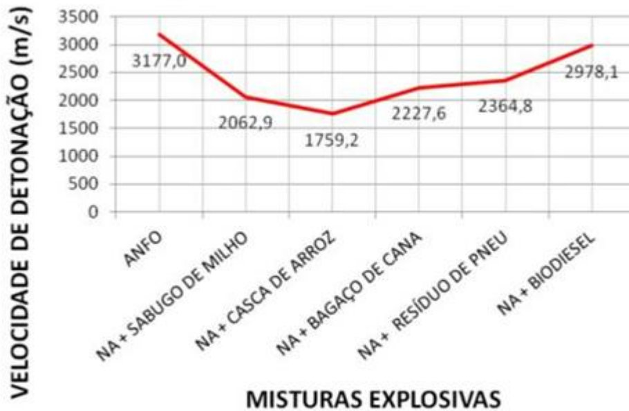
Gráfico 3 - Variação da velocidade de detonação em função de diferentes misturas
