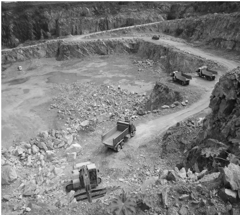
Figura 1: Formação de fila na operação de carregamento dos caminhões
