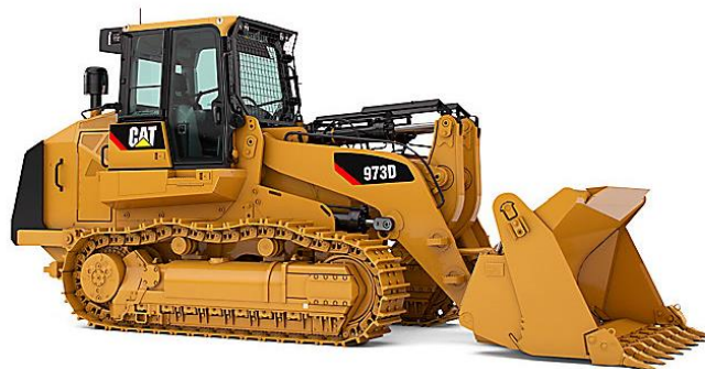
Figura 9: Pá-carregadeira sobre esteiras Caterpillar 973D
