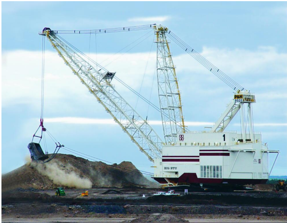
Figura 5: Escavadeira de Arrasto (Dragline)
