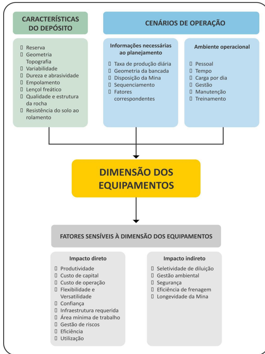
Diagrama 1: Considerações para a seleção de equipamentos e fatores sensíveis ao dimensionamento dos equipamentos
