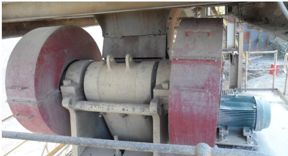
Figura 01: Britador Primário da Unidade de Beneficiamento da RML.
