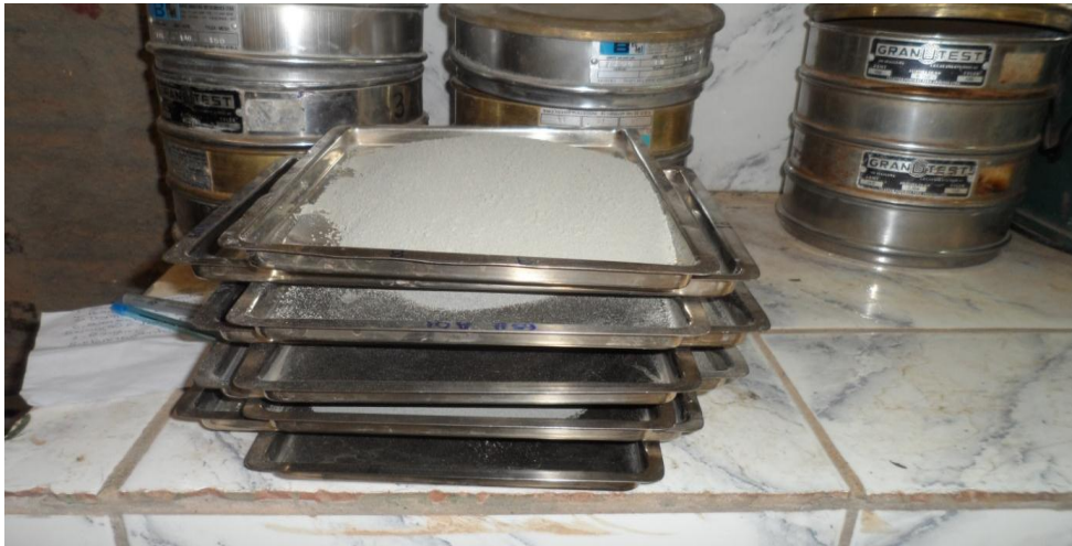
Figura 19: Separação Granulométrica da Amostra.
