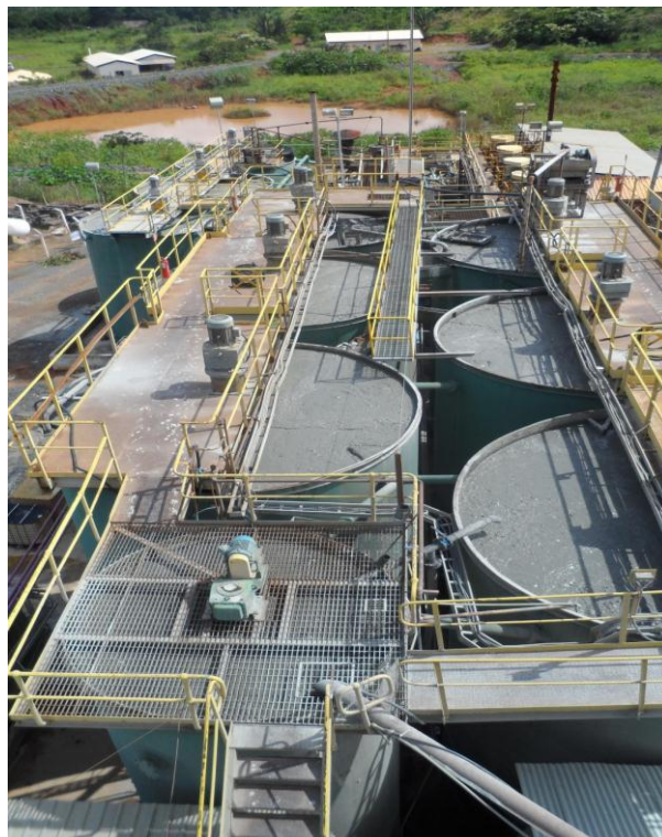
Figura 07: Lixiviação da Unidade Beneficiamento da RML.
