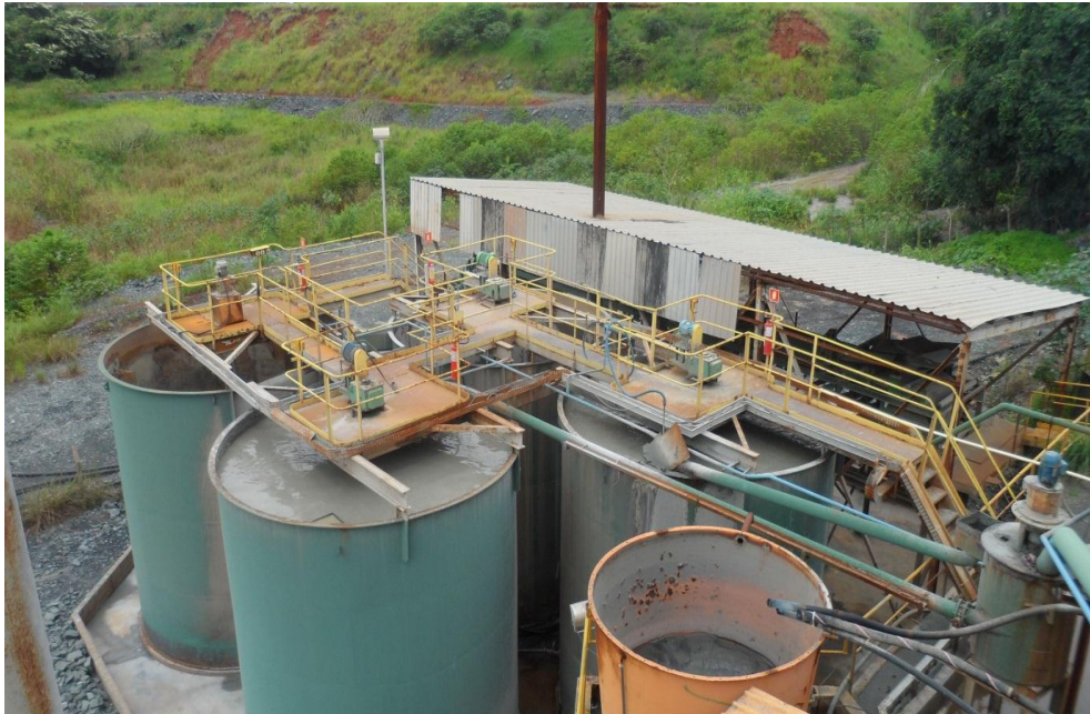
Figura 12: Tanques de Neutralização da Unidade de Beneficiamento da RML.
