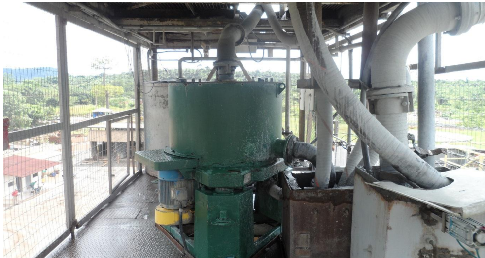
Figura 06: Equipamento Knelson da Unidade de Beneficiamento da RML.
