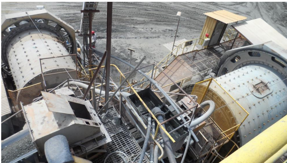
Figura 04: Britadores Cilíndricos de Bolas da Unidade de Beneficiamento da RML.
