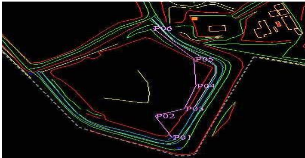
Figura 15: Pontos de Amostragem na Barragem de Rejeito na Unidade RML.
