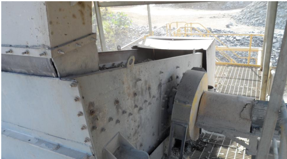
Figura 03: Peneira Vibratória da Unidade de Beneficiamento da RML.
