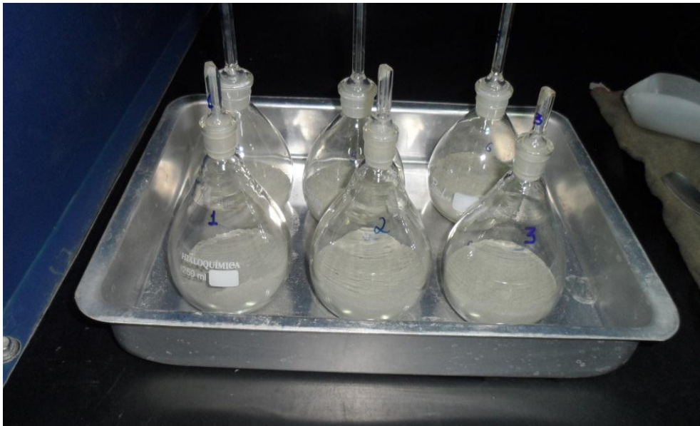
Figura 21: Amostra da Barragem no Picnômetro para Teste de Densidade.
