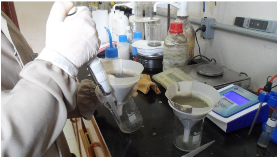
Figura 26: Processo de Neutralização do Cianeto Mostrando em Primeiro Plano o Material Analisado no Laboratório da Unidade RML.
