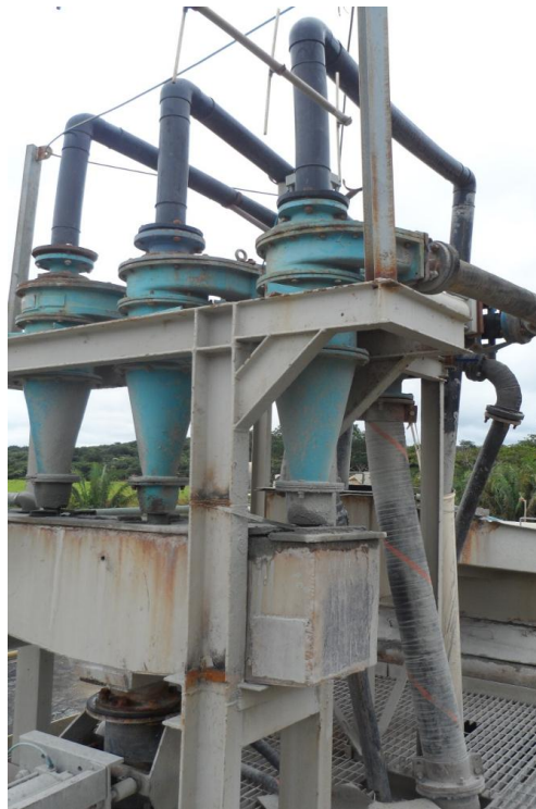
Figura 05: Equipamento de Hidrociclone da Unidade Beneficiamento da RML.
