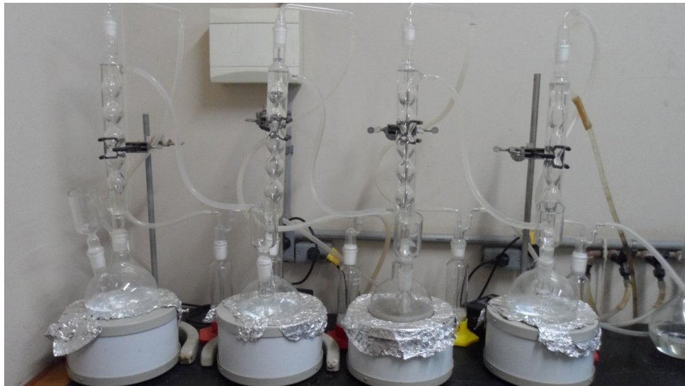
Figura 18: Teste de Concentração de Cianeto total.
