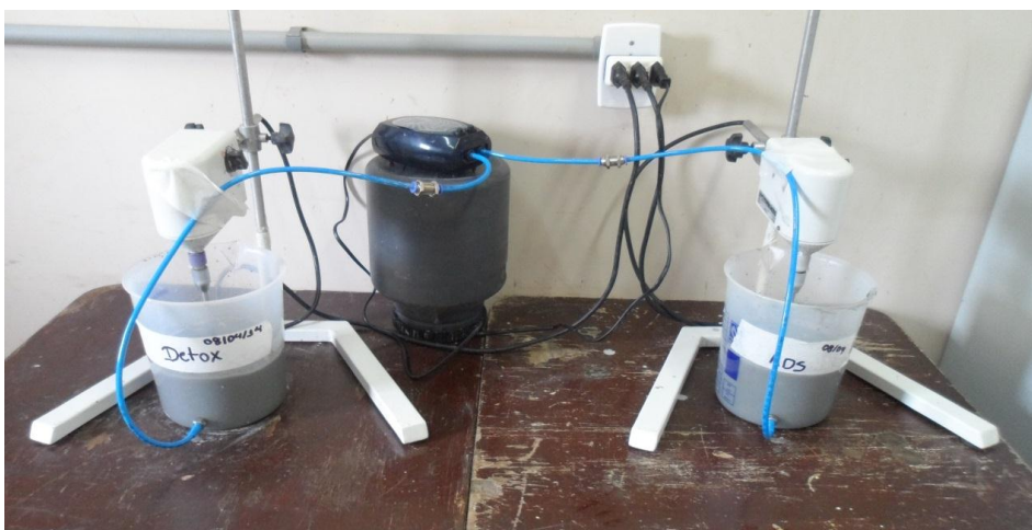
Figura 23: Lixiviação da Amostra do Detox e Adsorção.
