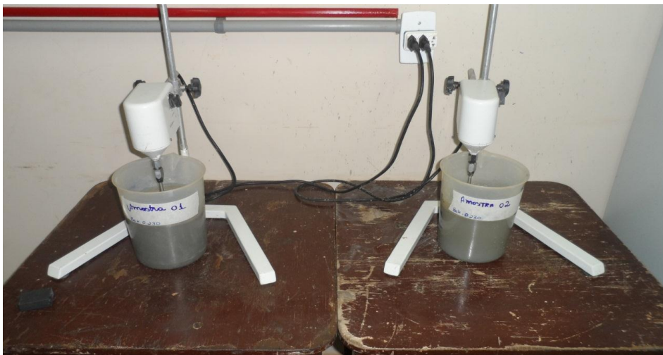
Figura 22: Lixiviação da Amostra da Barragem de Rejeito.
