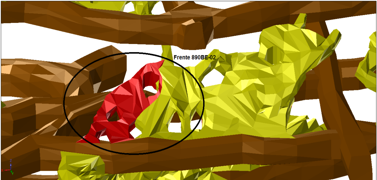
Figura 02 – Imagem em destaque demonstrando as feições topográficas da Frente 890BE-02. As formas em amarelo são as zonas já lavradas, as formas em vermelho foram às zonas lavradas em março/2014 e as formas em marrom são as galerias de acesso. Fonte: Imagem obtida no software SURPAC, maio/2014.
