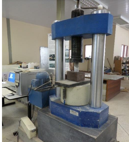
Figura 10: Local e equipamento em que foi realizado o teste de compressão simples. Fonte: Própria.
