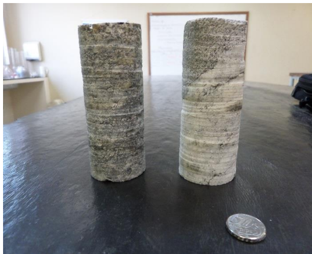
Figura 7: Testemunhos extraídos de blocos de rocha coletados in situ, na Jazida Rodolita I, em dois pontos distintos.
