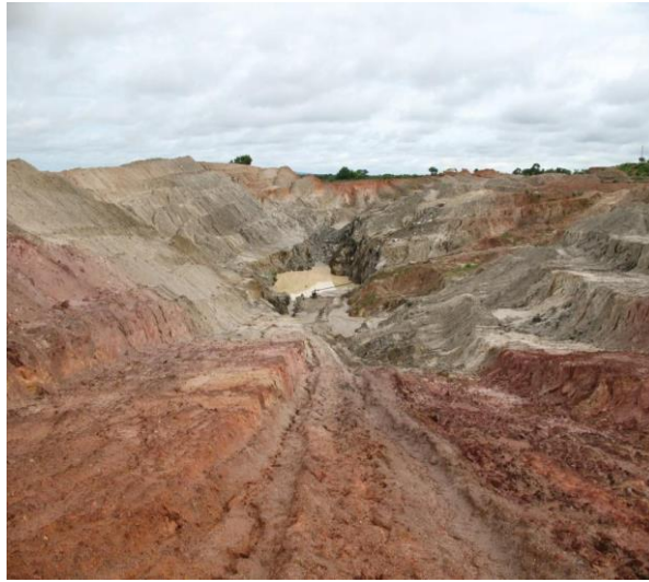
Figura 3: Jazida Rodolita I, Cava principal em Dezembro 2008, com os trabalhos de extração próximos à cota 315m, vista do sul para o norte. Lavra paralisada em fase manutenção do lençol freático rebaixado com bombeamento. Fonte: PAE - Processo número 860.787/2012.
