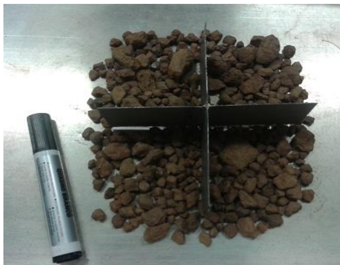
Figura 8. Quarteamento para obtenção de 25% da massa total
