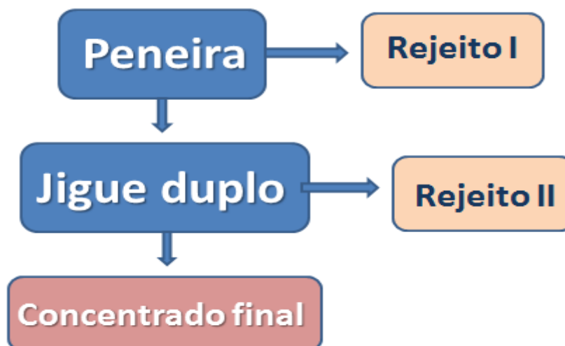
Fluxograma 3. Atual Configuração da Planta de Beneficiamento.
