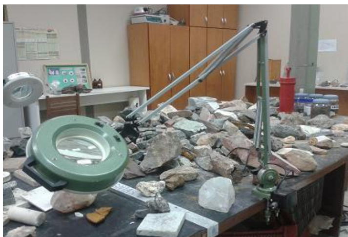
Figura 9. Lente de aumento utilizada na separação granulométrica manual.
