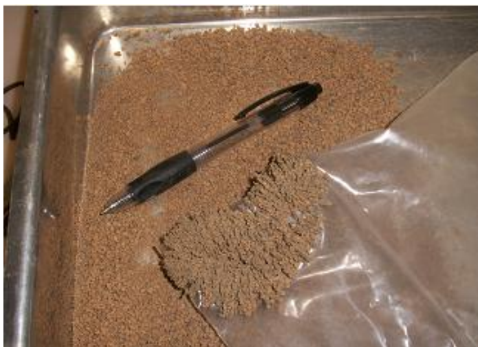
Figura 7. Separação magnética manual associada à classificação granulométrica.
