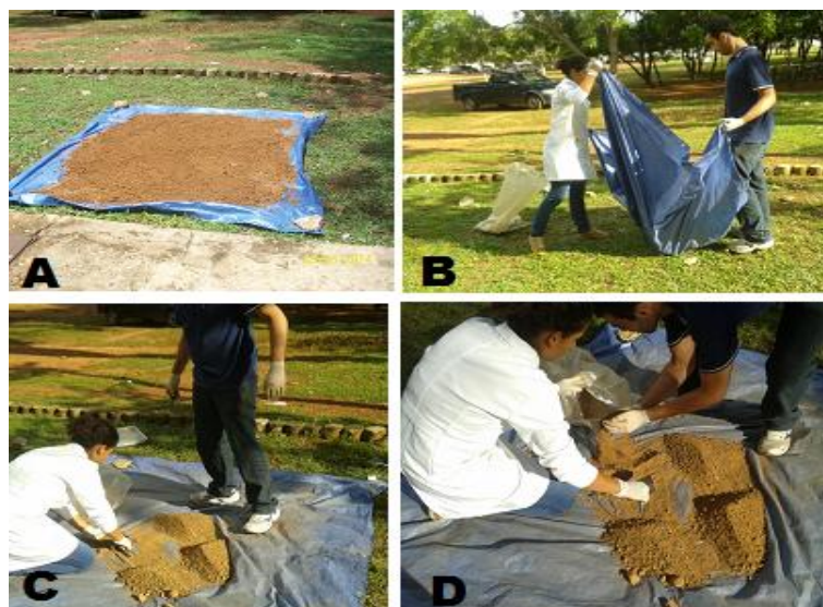
Figura 5. A) Amostra sendo seca naturalmente em exposição solar. B) Homogeneização. C) Quarteamento D) Separação de 1 fração de quarteamento.
