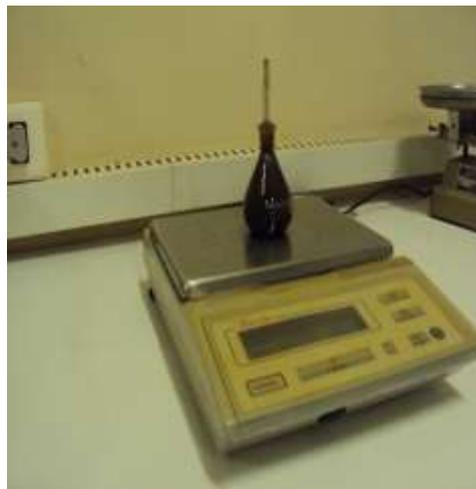
**Figura 08** – Representando o preparo para determinação da densidade das amostras. (a) balança como picnometro + água + AM – 01; (b) descartando a polpa e lavando picnometro.
