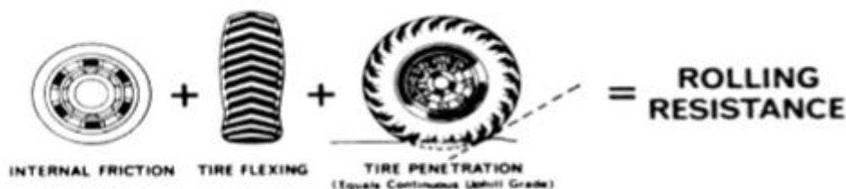
FIGURA 6. Resistência de rolamento gerada penetração, flexão e atrição.
