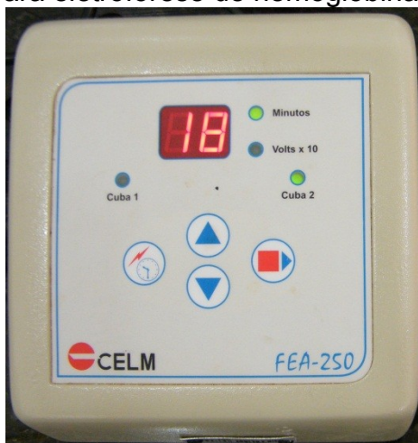
Figura 12 - Fonte para eletroforese de hemoglobina FEA-250, da CELM
