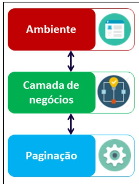
Conforme ilustrado pela Figura 13, o Ambiente é a parte visível para o usuário, em que há a interação do usuário com o ambiente e que apresenta graficamente a simulação do mecanismo. A Camada de Negócio é responsável por toda parte lógica da aplicação, que consiste em controlar o fluxo da informação, assim, sendo intermediária entre o Ambiente e a parte responsável pela simulação da Paginação. E, por fim, a Paginação representa a simulação do mecanismo de gerência de memória.
