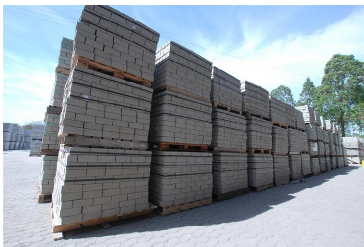
Figura 41: Estocagem dos blocos de concreto.
