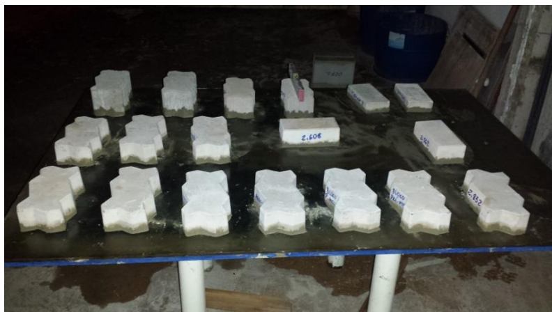
Figura 55: Capeamento das faces dos blocos (regularização).
