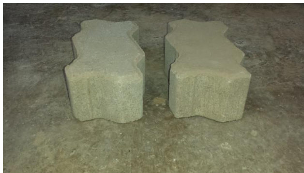
Figura 51: PPC 16 faces fabricada pela Empresa “E” (8x10x20 cm).
