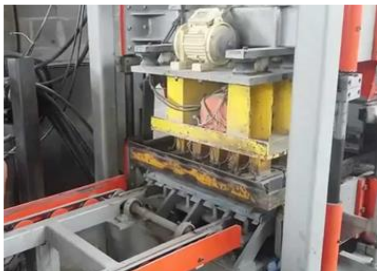
Figura 43: Moldagem automatizada das PPC
