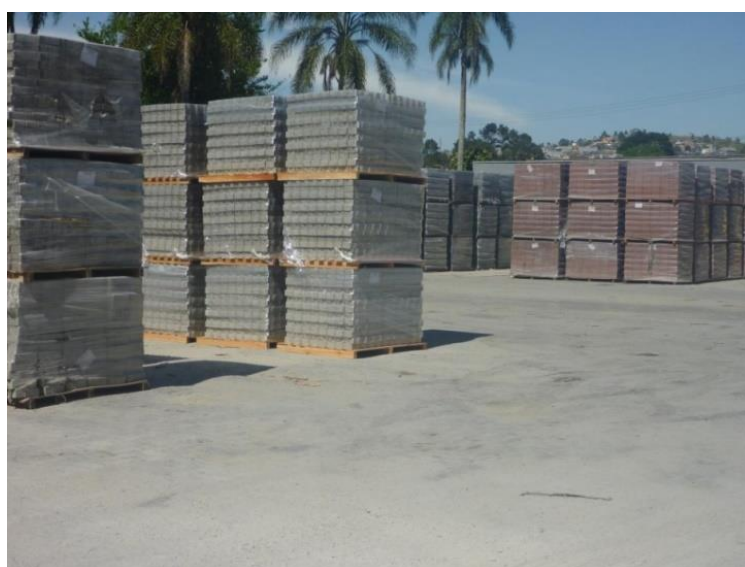
Figura 44: Estocagem de paletes com blocos de concreto.
