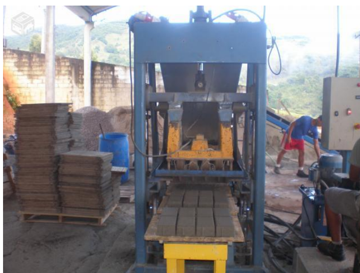
Figura 38: Moldagem dos blocos de concreto utilizando vibro-prensa.
