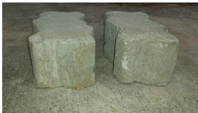
Figura 52: PPC 16 faces fabricada pela Empresa “H” e “J” (10x10x20 cm).
