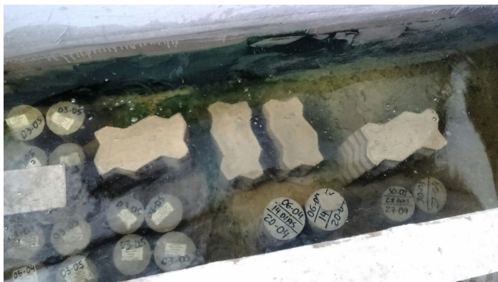
Figura 56: PPC submerso em água por 24h antes do rompimento.
