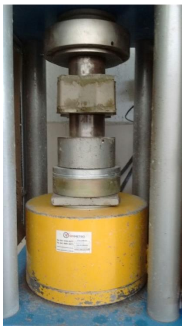
Figura 58: PPC em contato com as placas auxiliares (inferior e superior).
