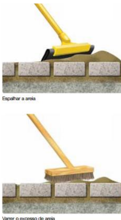
Figura 15: Preenchimento das juntas com agregado fino.
