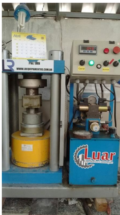
Figura 54: Prensa elétrica hidráulica 1 MN com indicador digital.
