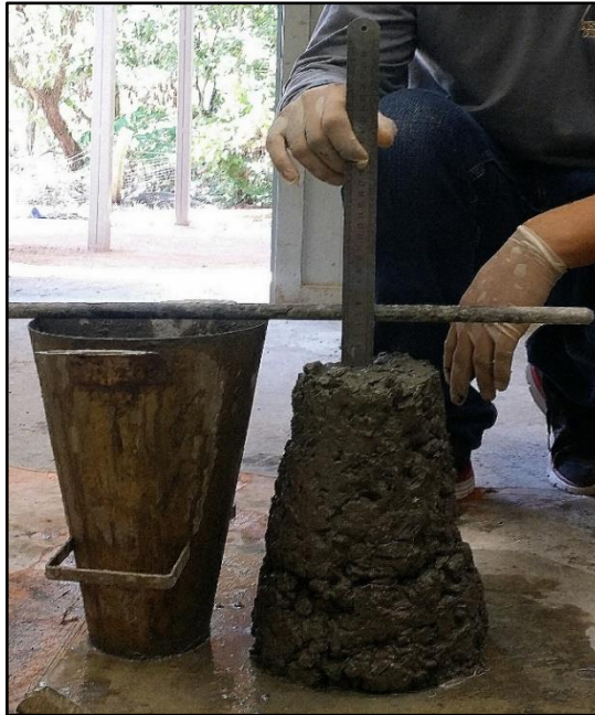
Figura 12 - Abatimento traço referência
