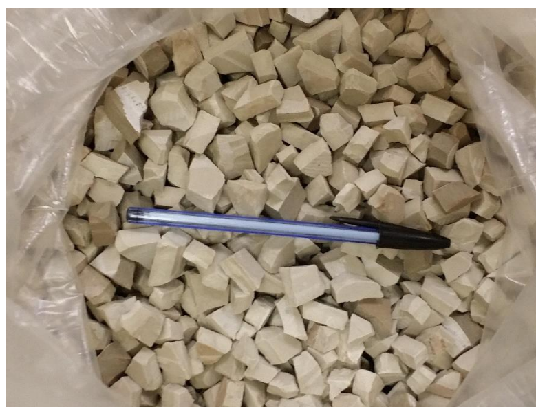
Figura 8 – Separação do porcelanato Moído
