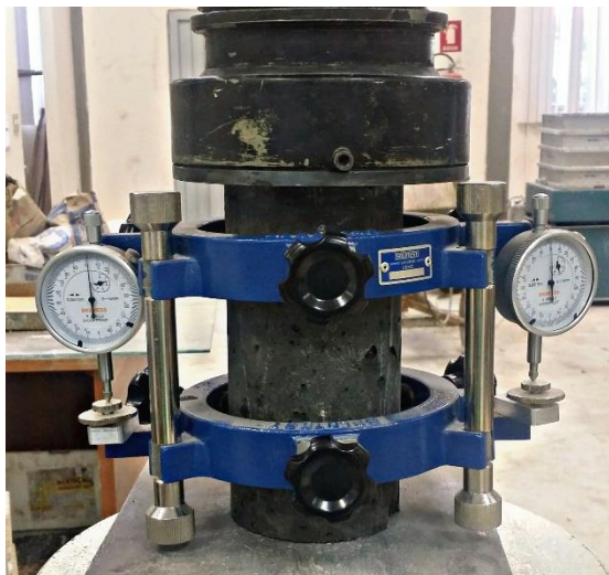
Figura 17 – Ensaio experimental - módulo de elasticidade
