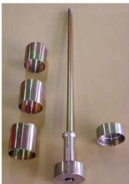
Figura 09 – Aparelhagem utilizada no ensaio de compactação de solos, soquete proctor e molde cilíndrico respectivamente.
