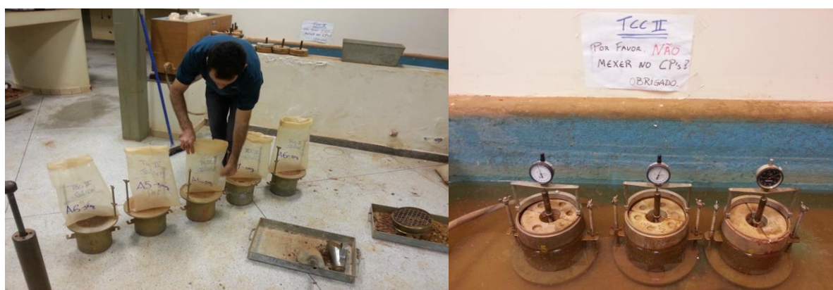
Figura 25: Compactação das amostras e amostra submersa.
