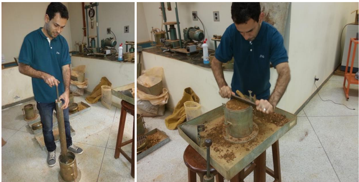
Figura 23: Compactando o solo e aplainando-se a superfície do material.
