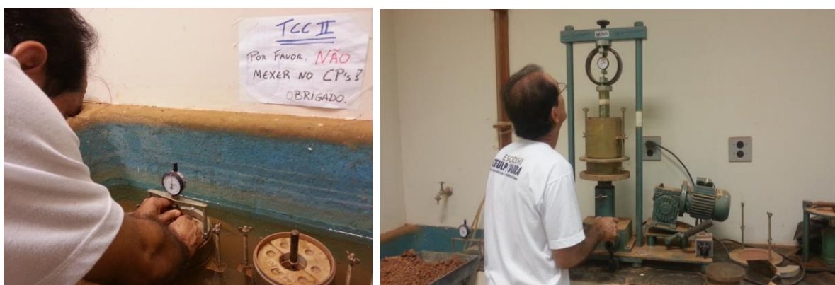
Figura 27: Amostra submersa e Execução do ensaio CBR.
