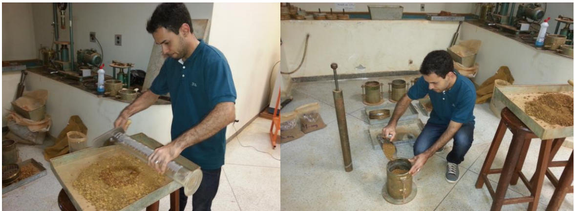
Figura 22: Homogeneização da amostra de solo da base e colocação das camadas do material.
