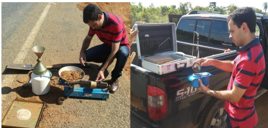
Figura 26: Determinação da massa específica e determinação do teor de umidade.
