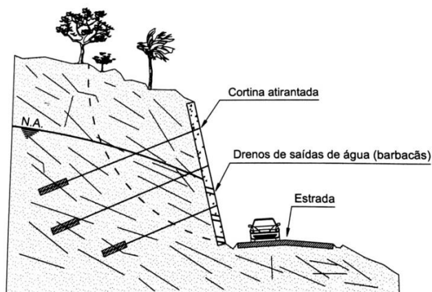
Figura 35 – Estrutura de cortina atirantada
