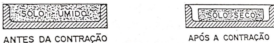
Figura 9 – Solo antes e após a contração total
