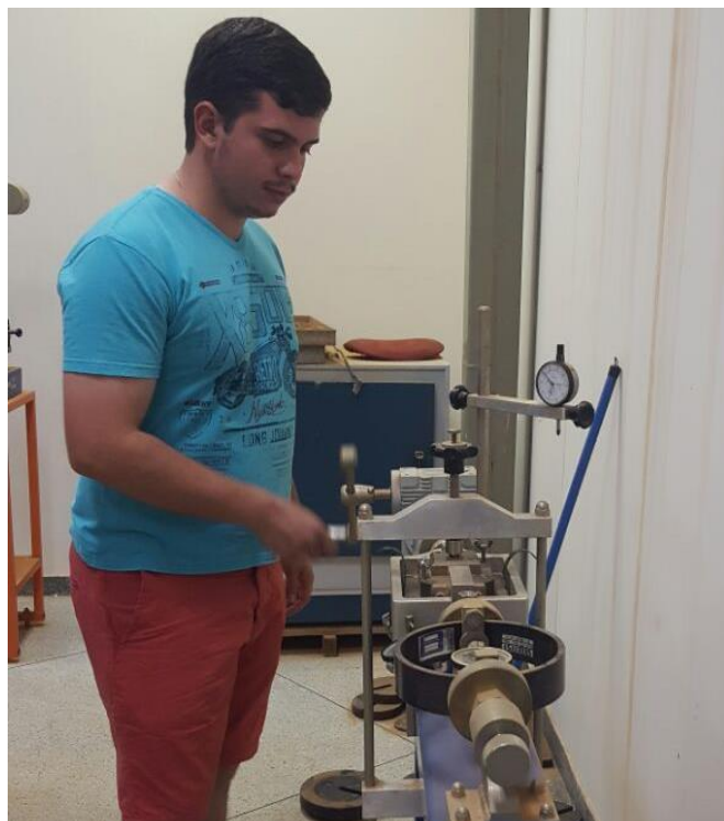
Figura 49 – Execução do ensaio de cisalhamento direto manual
