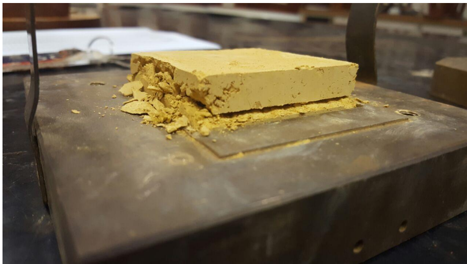
Figura 50 – Corpo de prova após ruptura por cisalhamento
