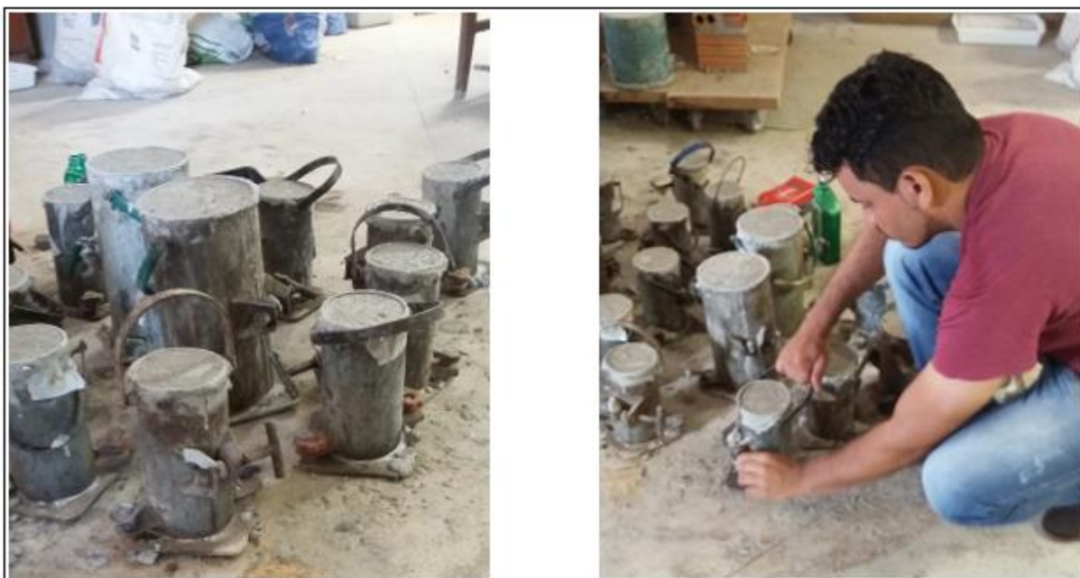
FIGURA 07 – Moldagem dos corpos de prova
