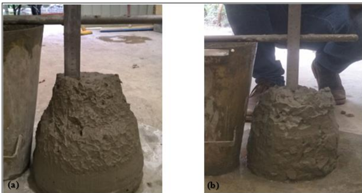
(a) Abatimento concreto referência, (b) Abatimento dosagem 25% - Fonte: Próprio Autor, 2016.
