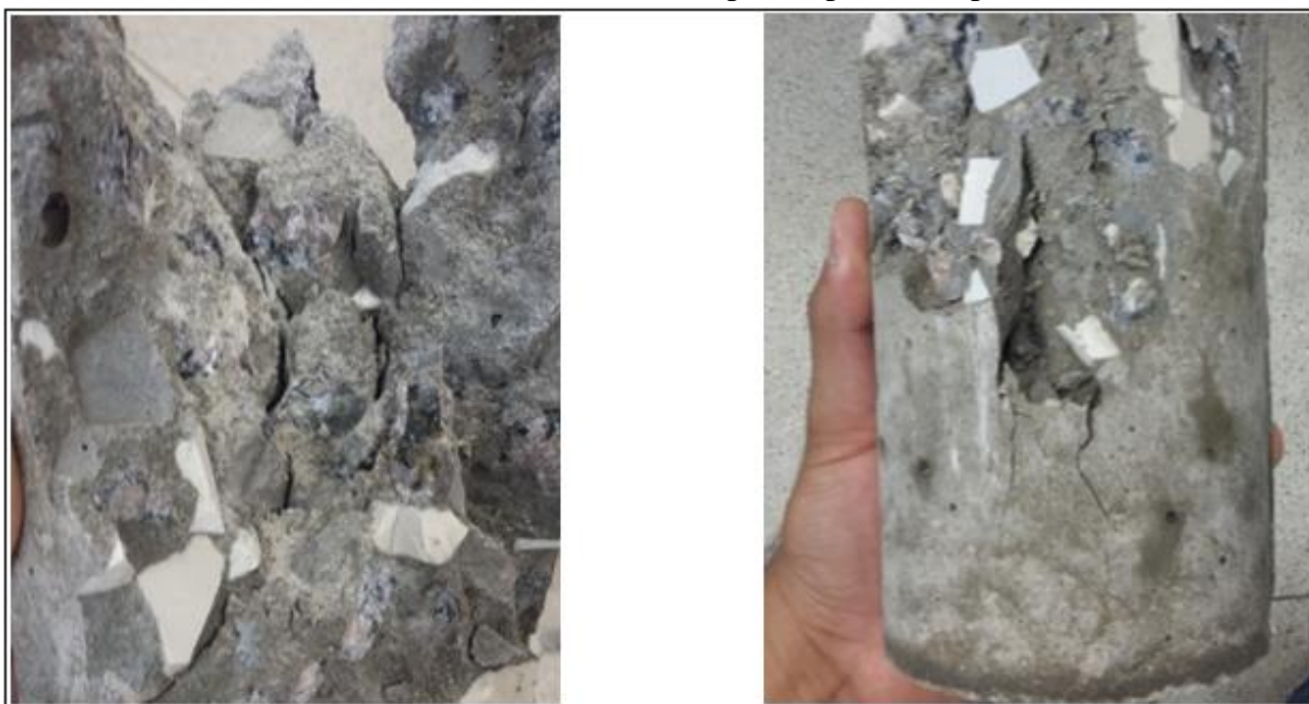
FIGURA 12 – Amostra dos corpos de prova rompidos
