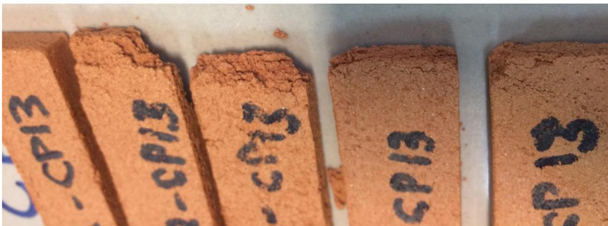
Iniciando a caracterização dos corpos de provas foram realizadas as análises das médias resultantes de cada formulação das composições, de retrações lineares e perda de massa ao fogo. Conforme na figura 10 o gráfico de retração linear, observa-se que na temperatura de 900°C houve alguns corpos de provas que expandiram como o caso F0, F2 e F3. Na temperatura de 950°C e 1000°C, os corpos de provas tiveram outro comportamento, em todos ocorreu retração.
