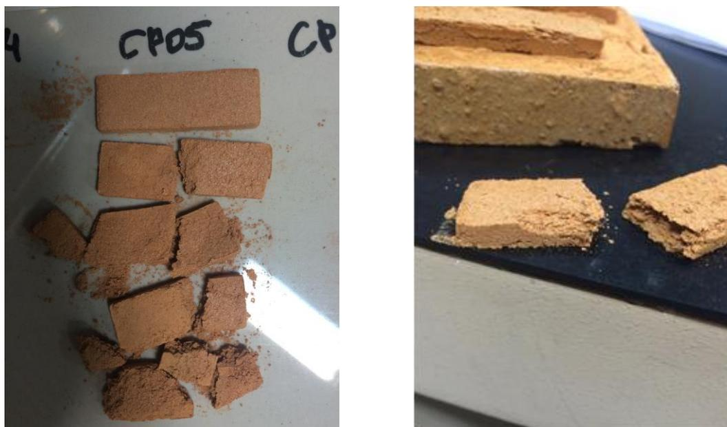
Na temperatura de 950°C a formulação F3 em que pode ser verificado na figura 8, não obteve resistência após a queima, devido as características do CP pela porosidade, foi eliminada das análises de absorção de água e resistência a flexão.
