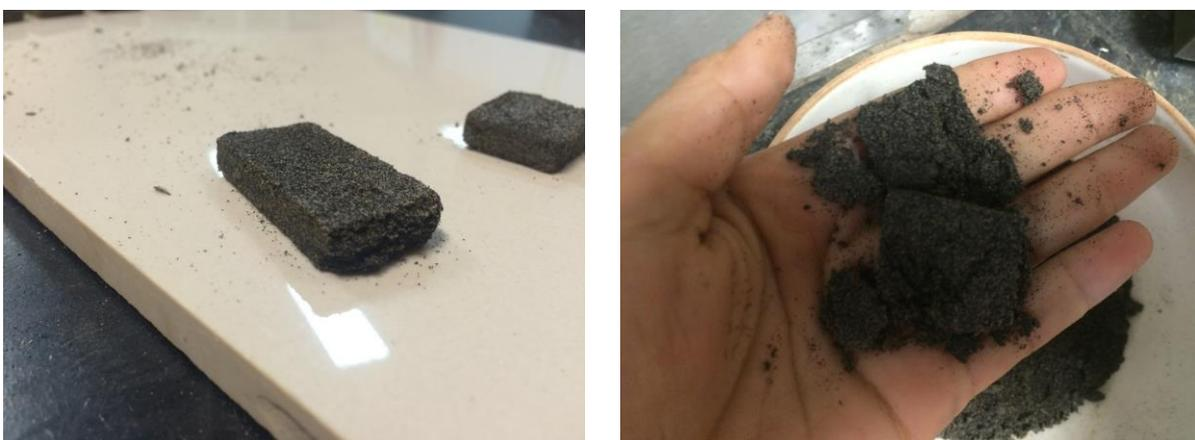
Depois da moldagem, os corpos de provas passaram para o processo de sinterização, no qual realizou-se um dia para cada temperatura de queima, totalizando assim 3 dias. A formulação F4 da composição para temperatura de 900°C não obteve resistência após a queima, sendo assim essa composição foi descartada para as demais temperaturas e posteriores análises. Na qual representada na figura 7.
