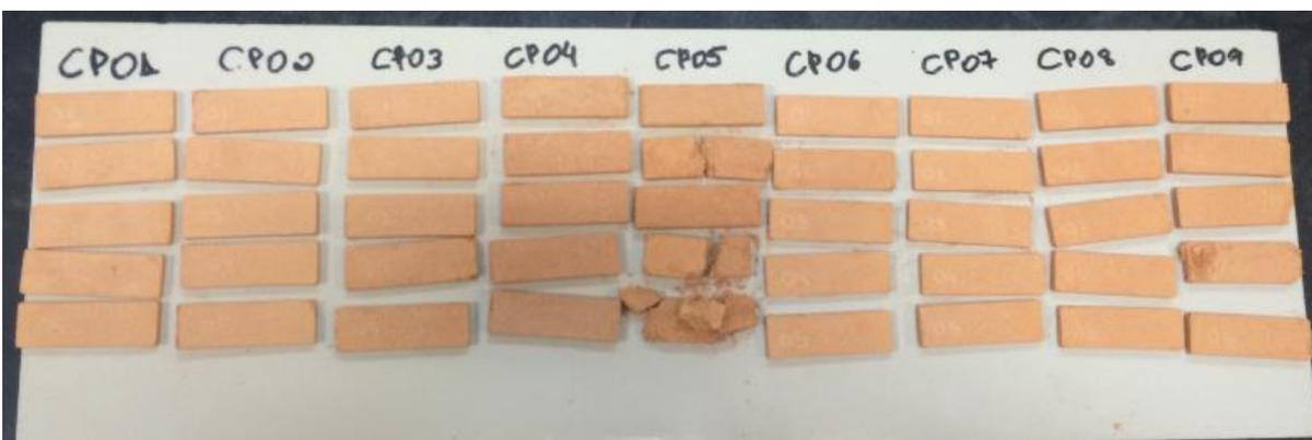
No gráfico de retração linear da figura 10, observa-se que os corpos de provas com adição da borracha tiveram maior retração nas temperaturas de 950° e 1000°C. Na temperatura de 900°C apenas ocorreu retração na formulação F1, as demais teve pequena expansão.
