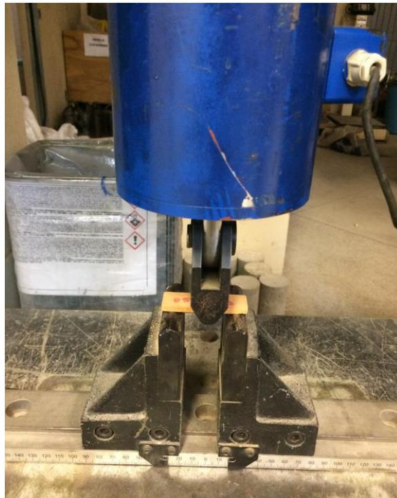
Através da análise do gráfico na figura 15, é possível verificar que a maior resistência a flexão foram nas formulações F0 na temperatura de 1000°C, e menor resistência nas formulações F2 na temperatura de 900°C.
