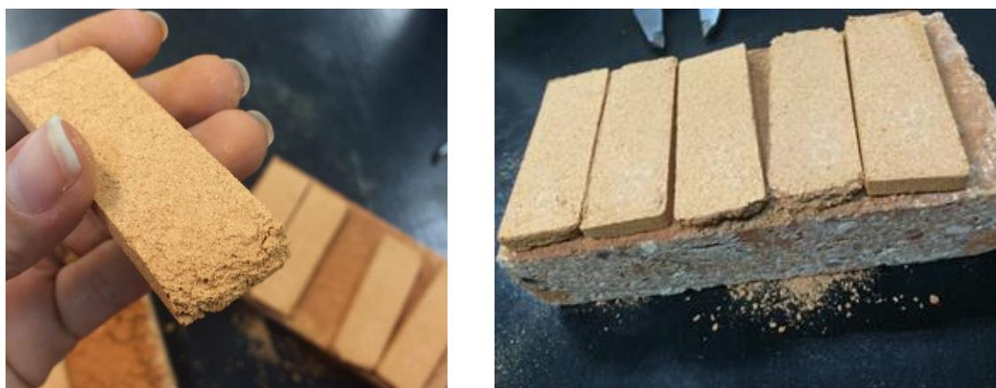
A formulação F3 na temperatura de 1000°C também não adquiriu resistência depois da queima, na figura 9 observa se a porosidade dos CP's, sendo assim descartada para as análises de absorção e resistência a flexão.
