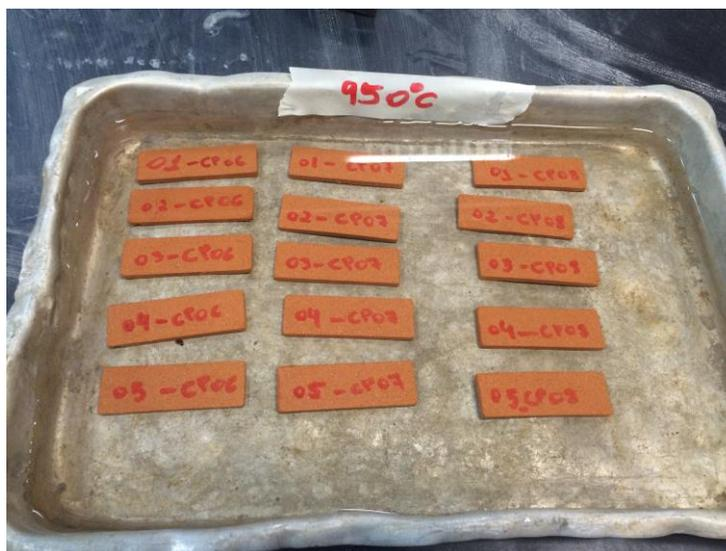
Posteriormente foi realizada a pesagem dos corpos de provas úmidos, com o tratamento de dados analisou-se que a formulação F3 na temperatura de 900°C obteve média de absorção de água 21%, na qual foi descartada devido o limite máximo admissível ser 20% e para melhor representação do gráfico abaixo.
