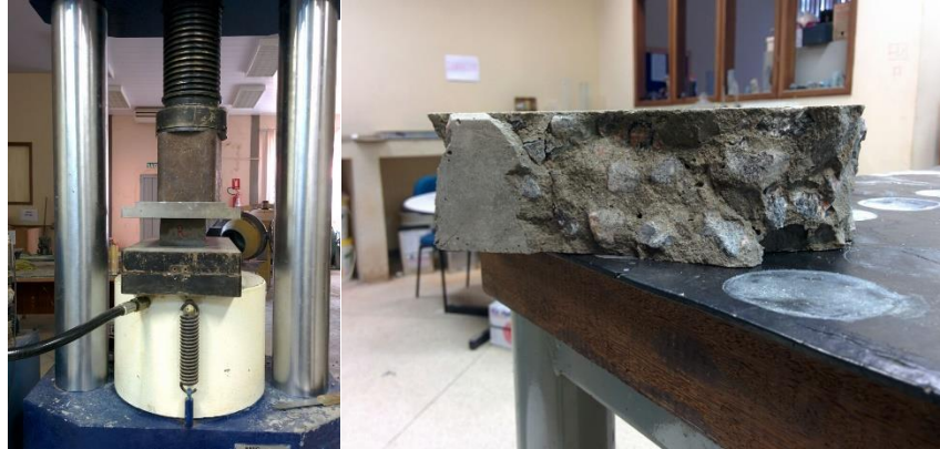
Figura 25 - Ensaio de resistência a compressão até o rompimento do corpo de prova
