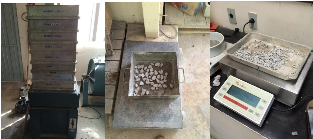
Figura 12 - Ensaio de granulometria do agregado reciclado
