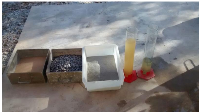
Figura 18 - Insumos utilizados para confecção dos blocos de concreto
