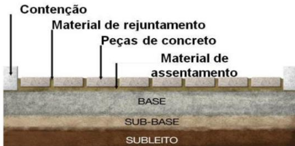
Figura 1 - Seção típica de pavimento intertravado (BROTTI, 2014)
