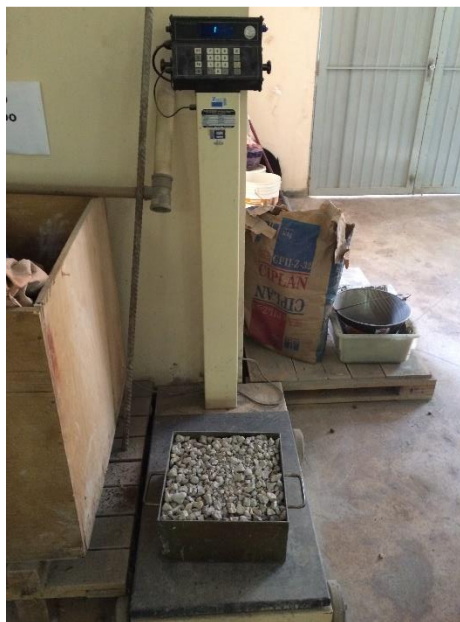
Figura 13 - Ensaio de massa unitária do agregado reciclado
