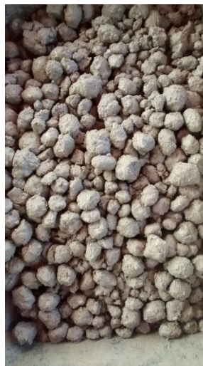
Figura 22 - Estado do concreto com substituição parcial de 60% do agregado natural
