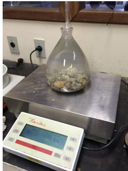
Figura 14 - Ensaio de massa específica do agregado reciclado
