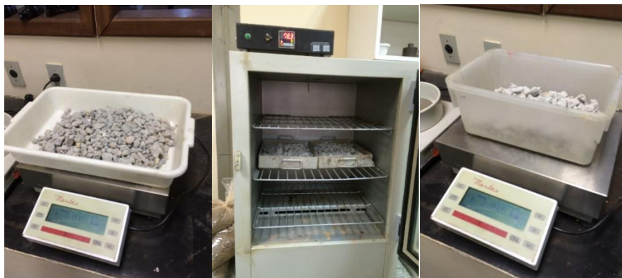
Figura 15 - Ensaio para determinação de absorção de água do agregado reciclado
