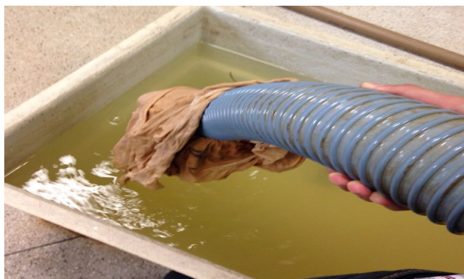
Figura 8, retirada do filtro do reservatório para coletar o material transportado.
