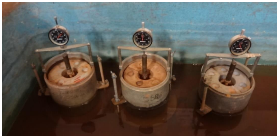
Figura 20: Corpos de Prova imersos com medidor de expansão.
