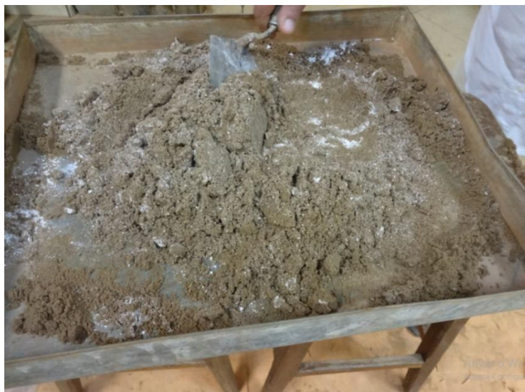
Figura 17: Mistura do solo + cal + estabilizante.
