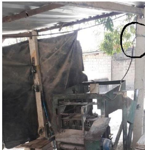
Figura 26: Fiação exposta e sem proteção – Fonte: Própria
