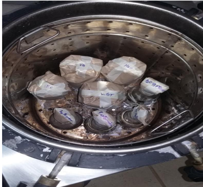
Figura 16.0 – Tubos de ensaio em auto clave para preparação de amostras de coliformes.
