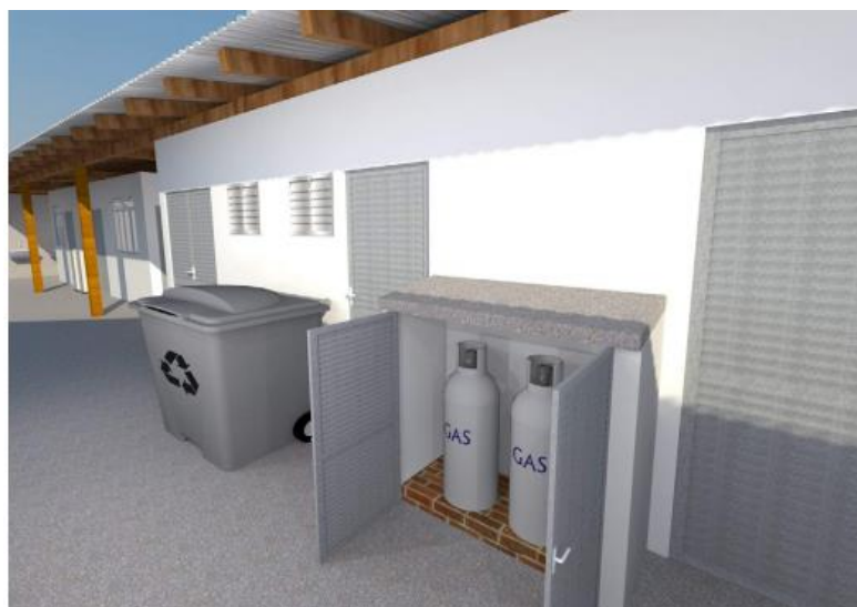
Figura 17 - Modelo de Abastecimento de GLP para cozinha
