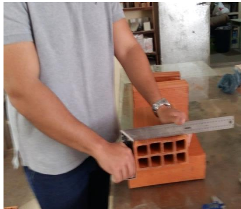
Figura 30 - Determinação do desvio em relação ao esquadro e da planeza das faces
