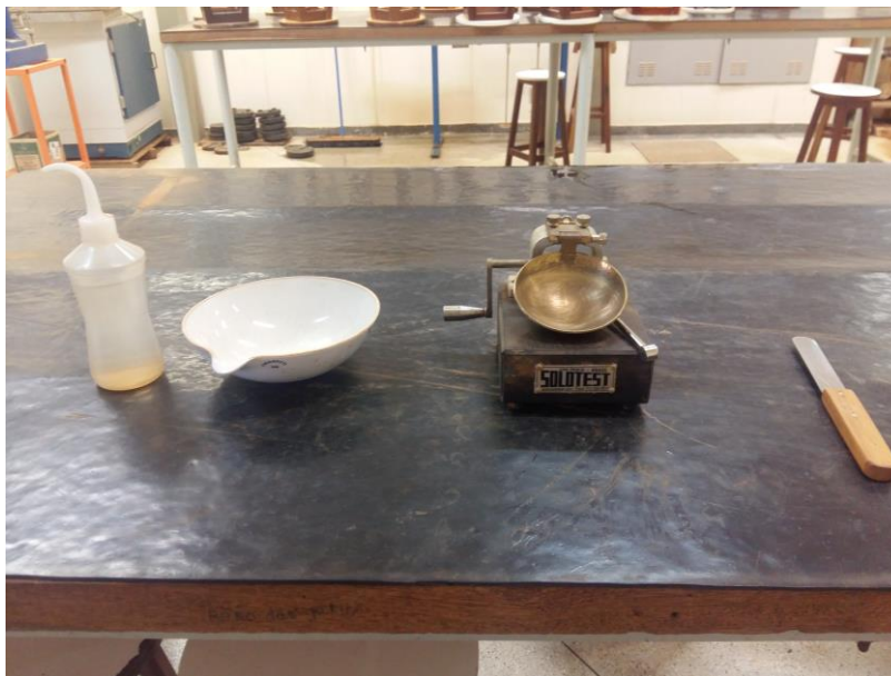
Figura 28: Equipamentos utilizados para determinação do limite de liquidez
