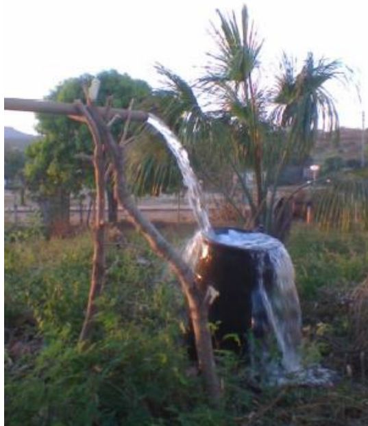
Figura 19 - Realização do procedimento de teste de vazão (método volumétrico).
