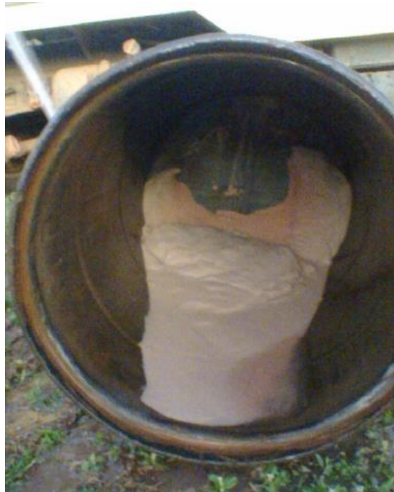
Figura 25 - Quantidade de areia depositada no fundo do tampo de PVC 220L depois do teste de vazão.
