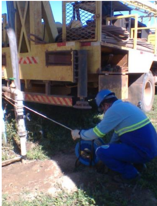
Figura 26 - Medição de níveis durante procedimento de teste de vazão.
