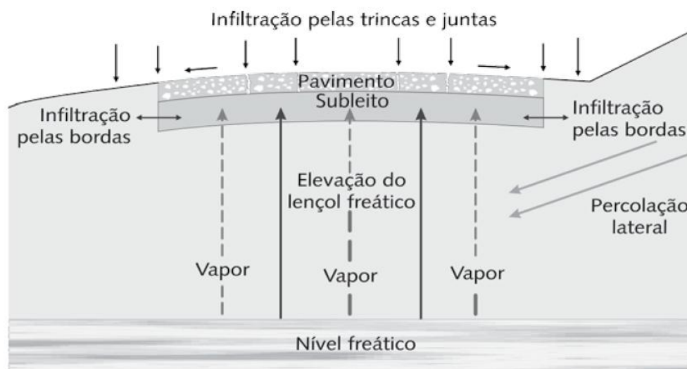
Figura 4- Representação da Infiltração no Pavimento Asfáltico
