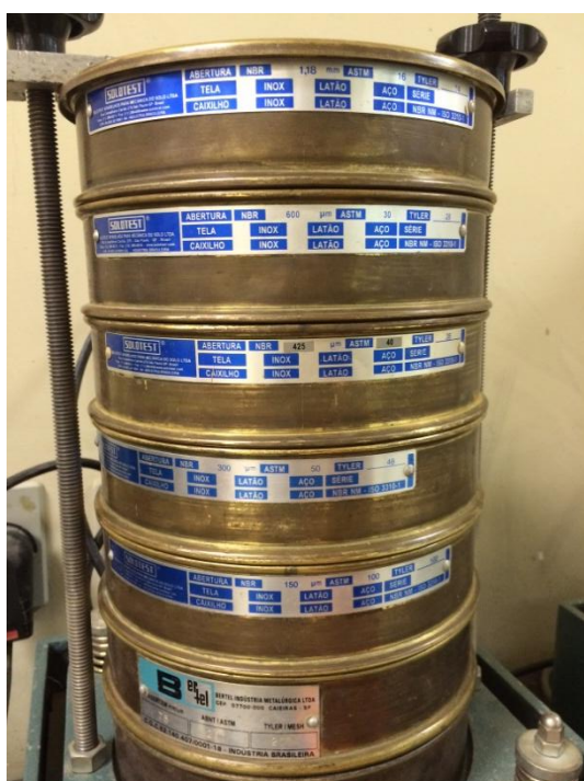
Foto 07 - Ensaio Granulometria - Peneiramento Fino
