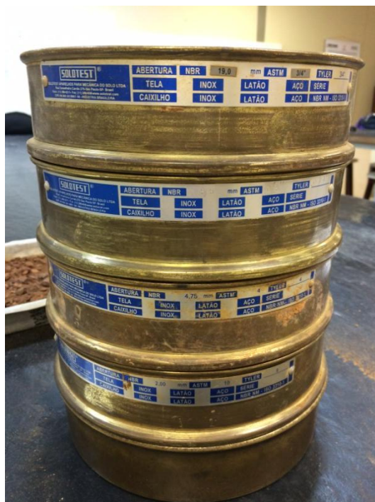
Foto 06 - Ensaio Granulometria - Peneiramento Grosso
