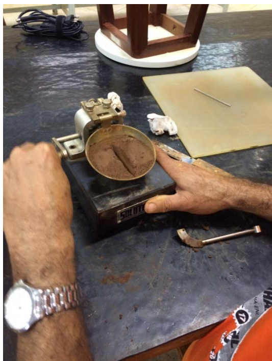
Foto 05 - Ensaio Limite de Liquidez e Plasticidade
