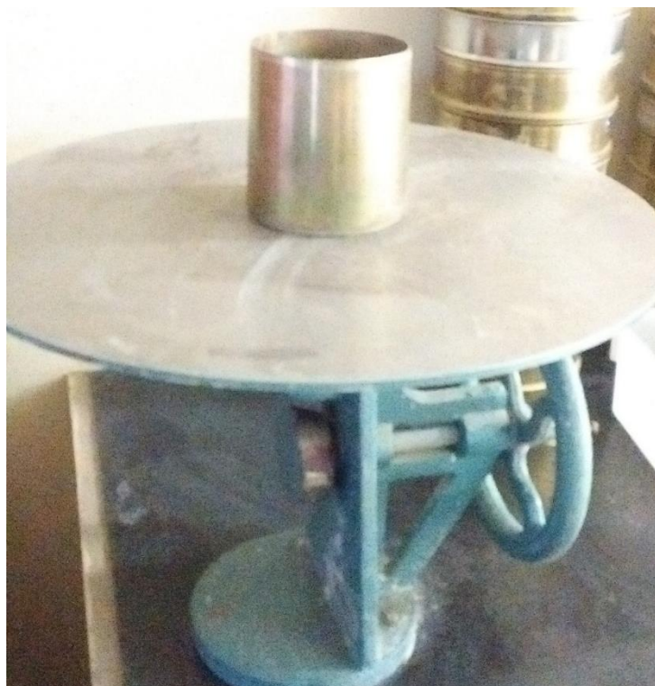
Figura 16 - Equipamentos utilizados para realização do ensaio de consistência.
