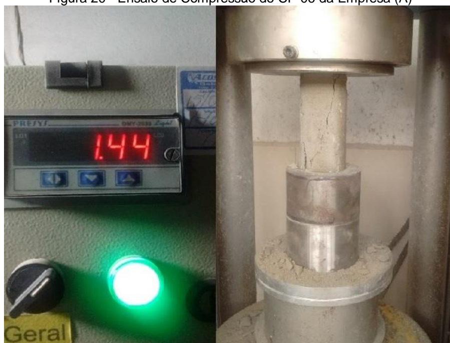
Figura 20 - Ensaio de Compressão do CP 06 da Empresa (A)
