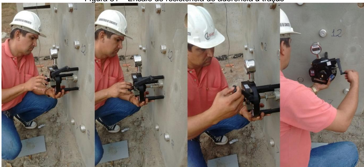
Figura 31 – Ensaio de resistência de aderência à tração
