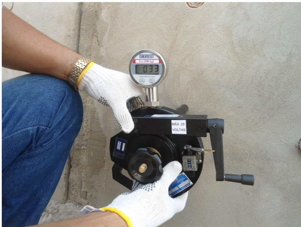
Figura 8 - Aparelho dinamômetro devidamente aferido para a execução do ensaio de arrancamento.
