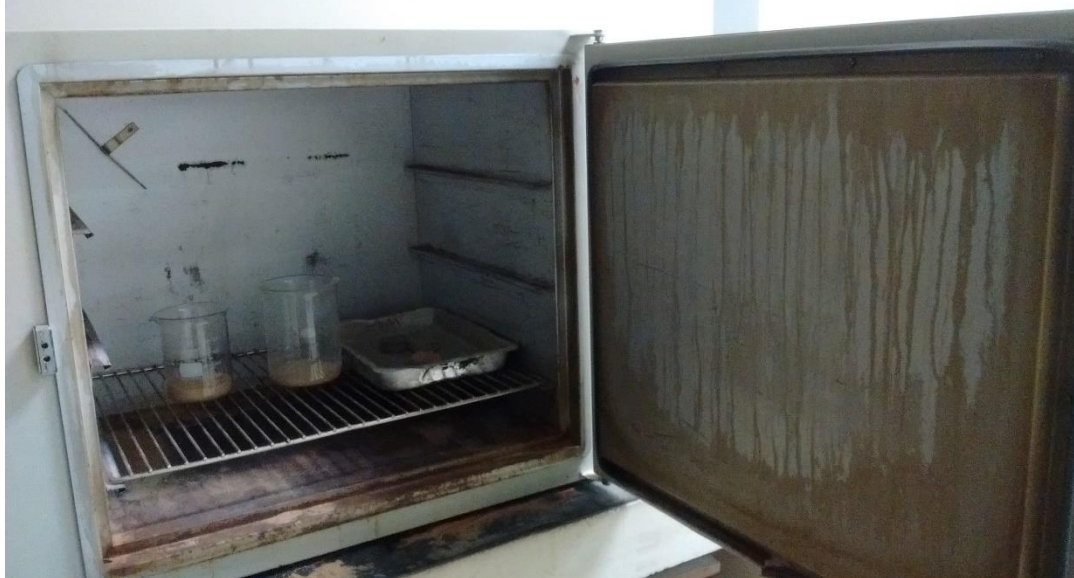
Figura 30 – CP's dentro da estufa à 105°C conforme a norma
