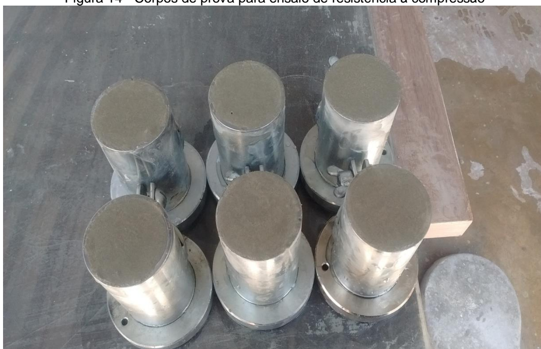
Figura 14 - Corpos de prova para ensaio de resistência à compressão
