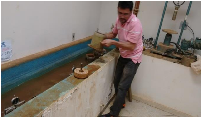
Figura 27a: Retirada dos corpos de prova da imersão
