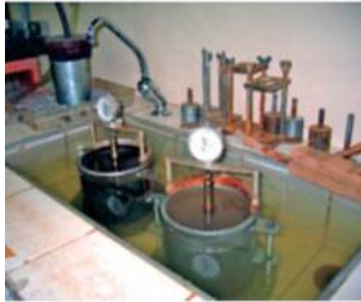
Figura 15: Corpos de prova imersos
