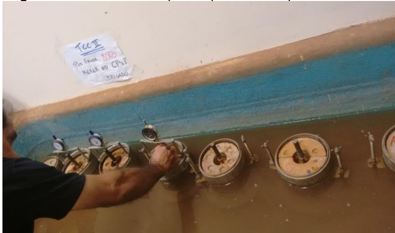
Figura 26: Imersão dos corpos de prova no tanque
