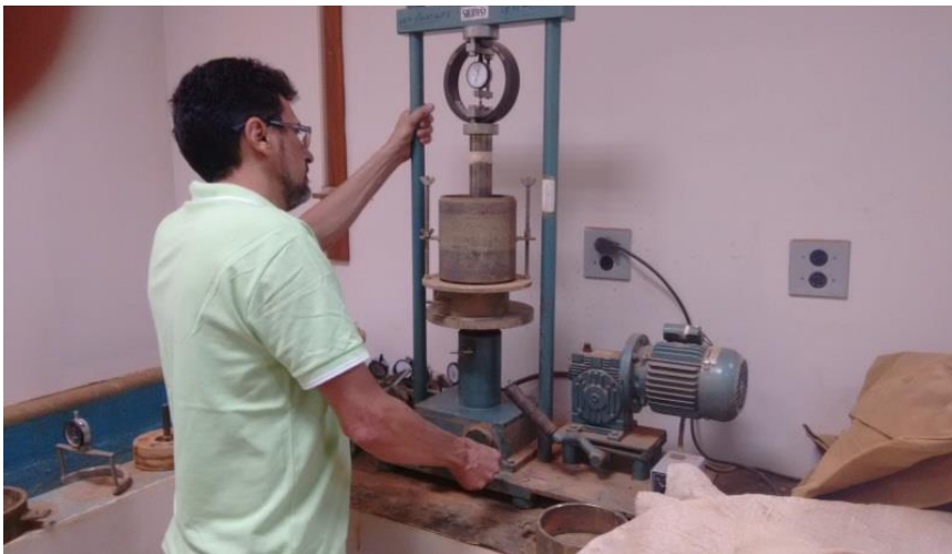
Figura 27c: Corpos de prova na prensa
