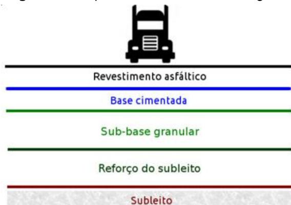
Figura 4: Croqui do Pavimento Semi - Rígido
