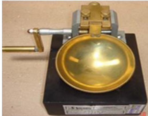
Figura 9: Aparelho de Casagrande
