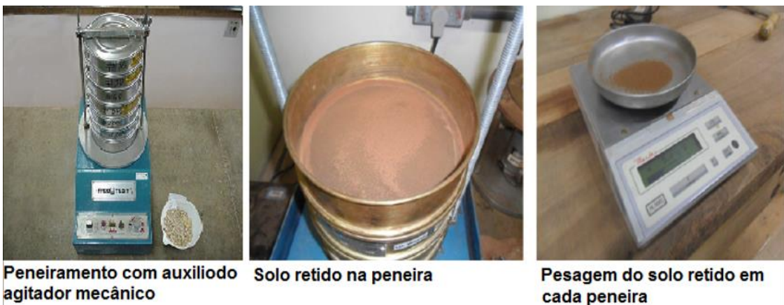
Figura 8: Sequência do ensaio de granulometria
