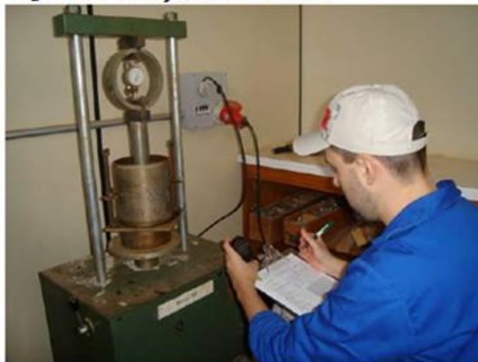
Figura16: Execução do ensaio CBR
