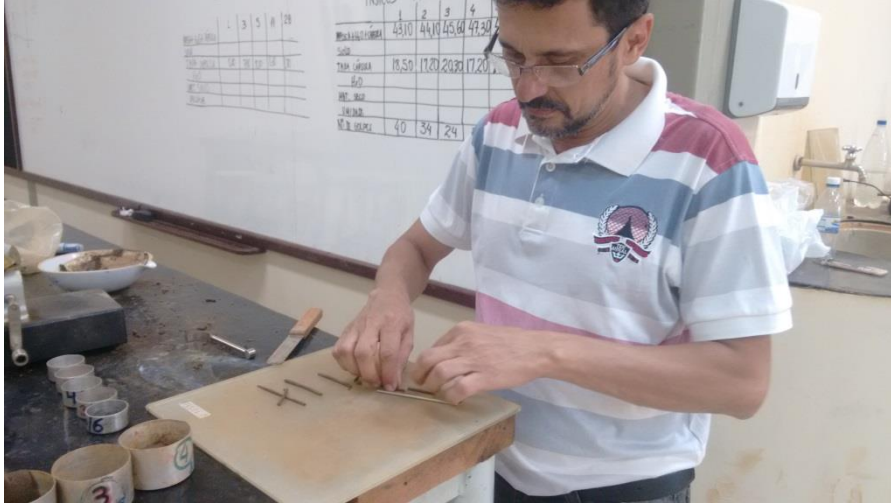
Figura 24: Ensaio do Limite de plasticidade
