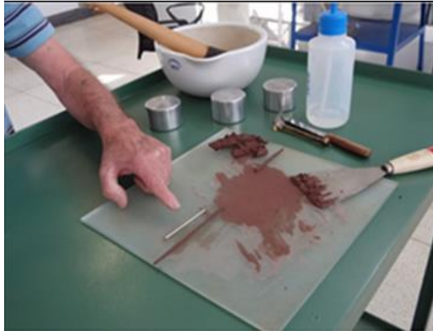
Figura 11: Ensaio de Limite de Plasticidade
