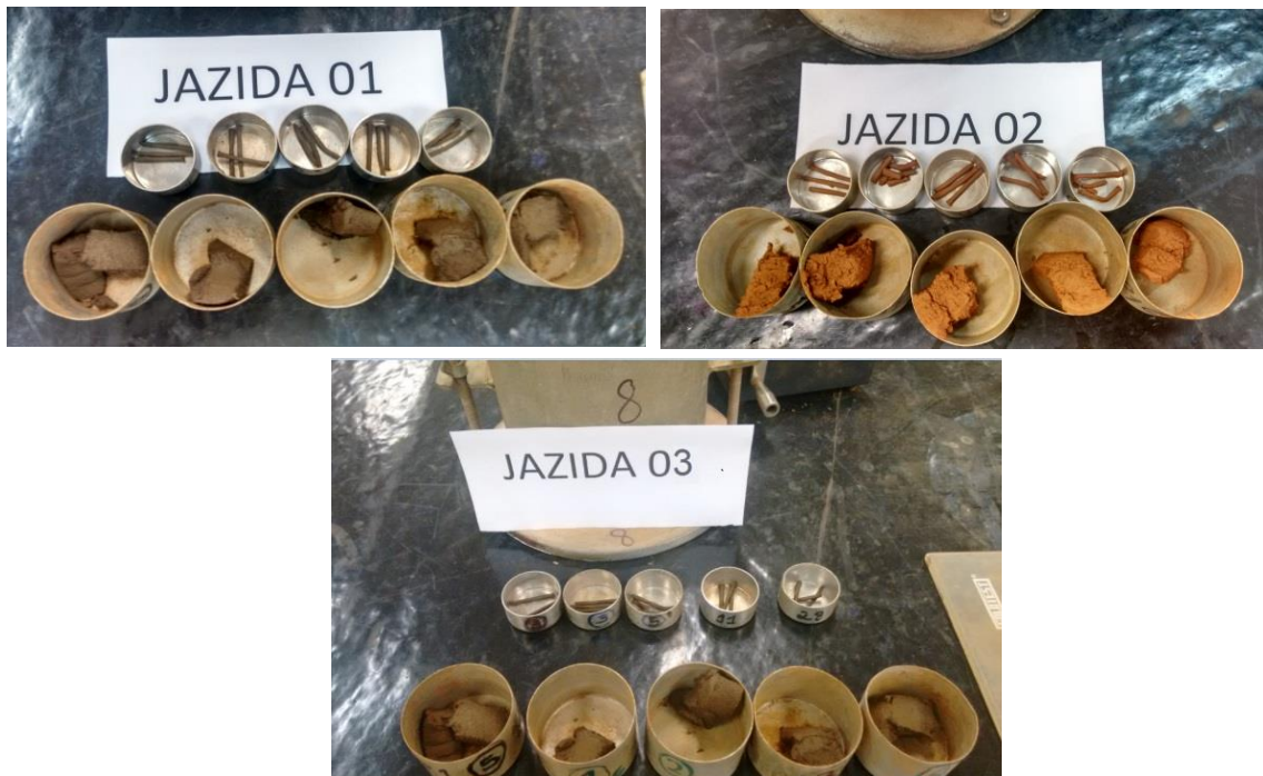
Figura 23: Limite de liquidez e Limite de plasticidade juntos
