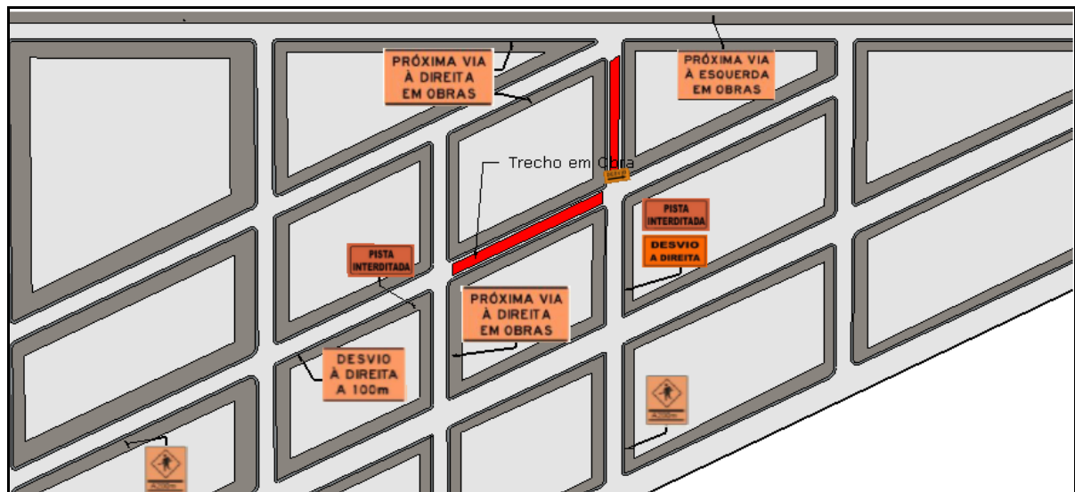
Fig.12: Modelo de sinalização com duas pistas interditadas
