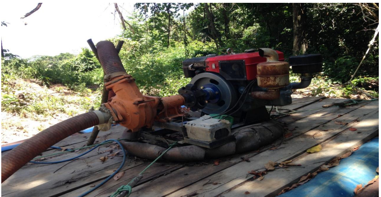
Figura 28 – Draga utilizada na extração da areia. Fonte: Autor, fevereiro de 2016.
