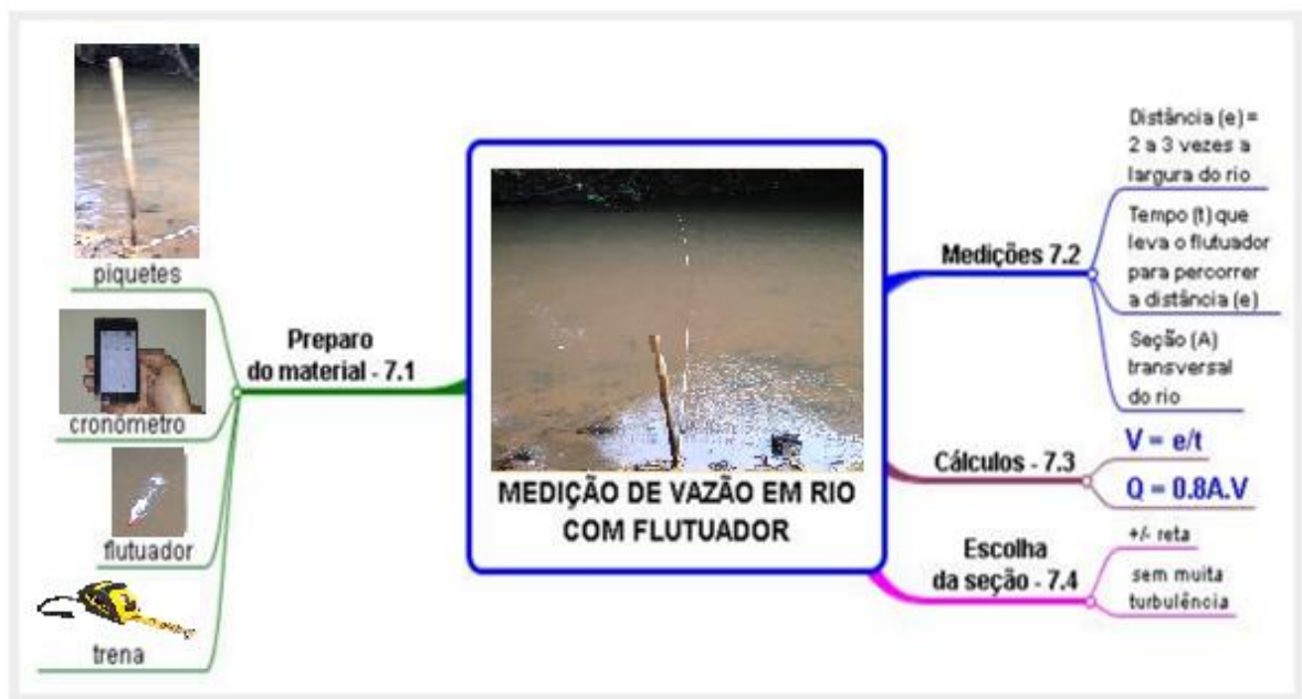
Figura 36 – Esquema para a medição de vazão em rio com flutuador. Adaptado de UFRRJ (2016).
