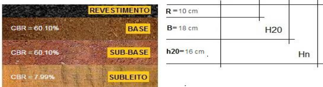
Imagem 22: Perfil do pavimento, cálculo manual (com tráfego BR 153 ano 1990).
