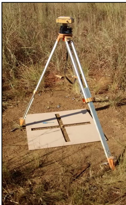
FIGURA 28. Captura de ponto com GPS geodésico. Fonte: Autor.
