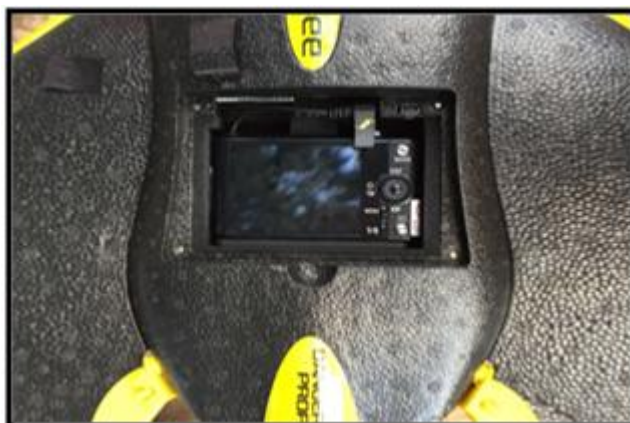
FIGURA 17. Ilustração de como a câmera é acoplada ao VANT. Fonte: autor
