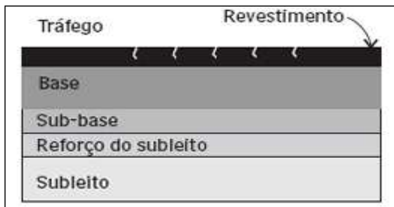
Figura 1 – Estrutura de pavimento flexível tipo (Fonte: Bernucci et. al., 2007)
