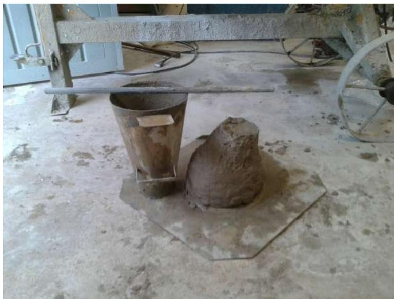
Figura 15 - Slump teste do concreto com 5% de lodo Calcinado
