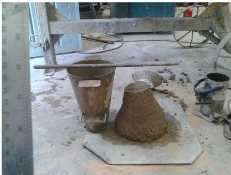
Figura 16 - Slump teste do concreto com 10% de lodo Calcinado
