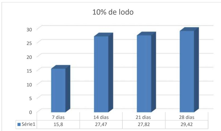
**Figura 21-** Resistência dos corpos de prova de 10% de lodo calcinado
