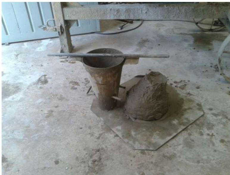
Figura 14 - Slump teste do concreto com 0% de lodo Calcinado
