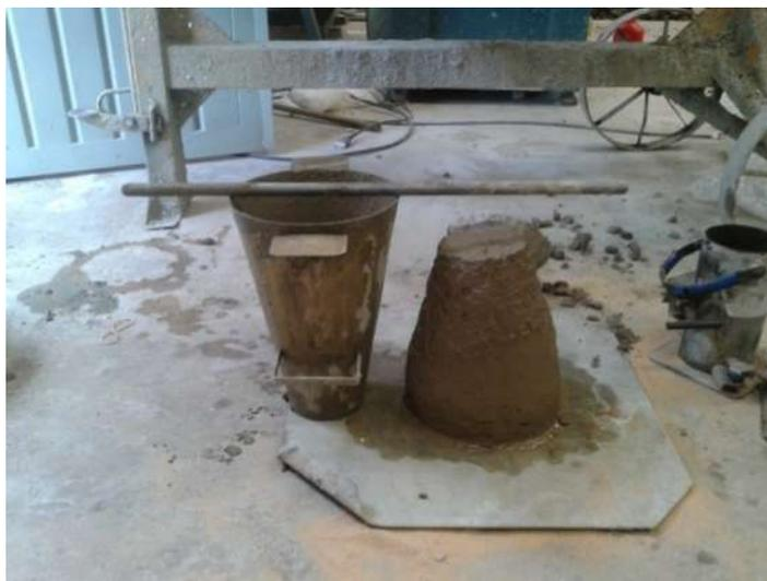
Figura 17 - Slump teste do concreto com 20% de lodo Calcinado
