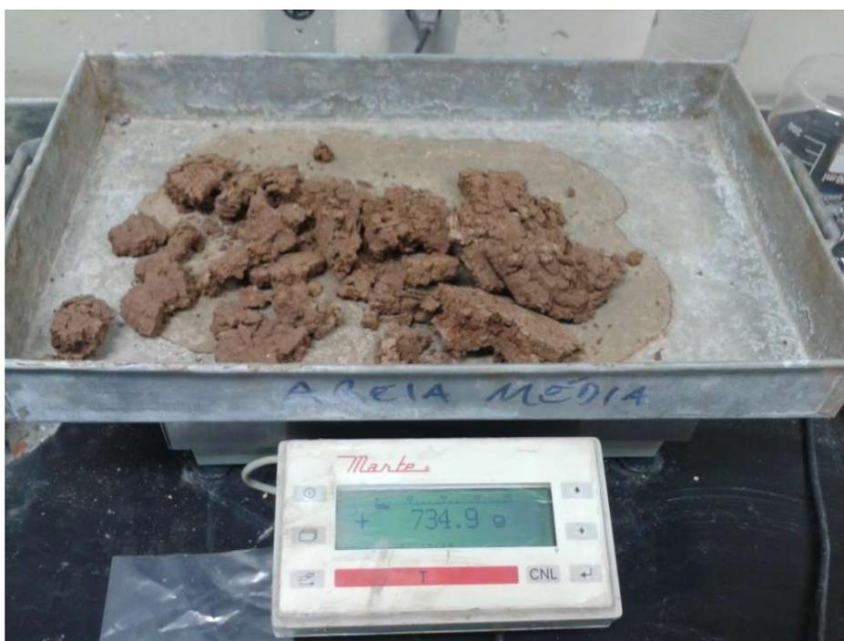
Figura 8 - Lodo após secagem
