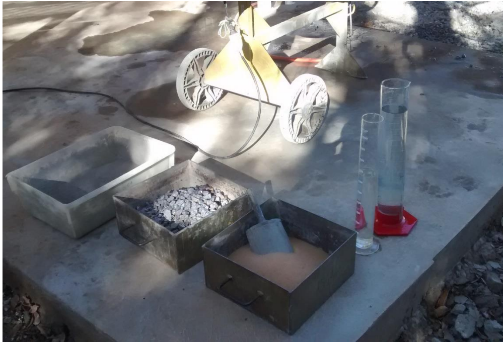
Figura 7 - Proporcionalamento dos materiais constituintes do concreto.
