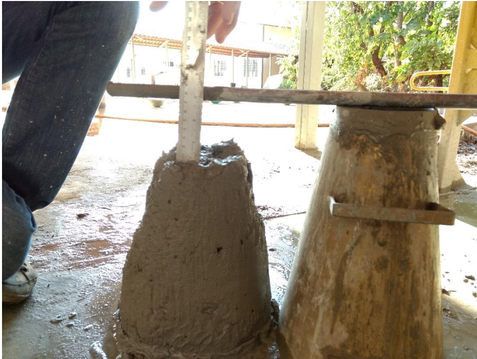
Figura 9- Slump do concreto com 25% de substituição.
