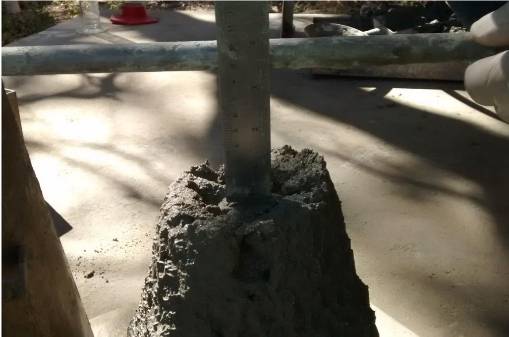
Figura 10 - Slump do concreto com 50% de substituição.
