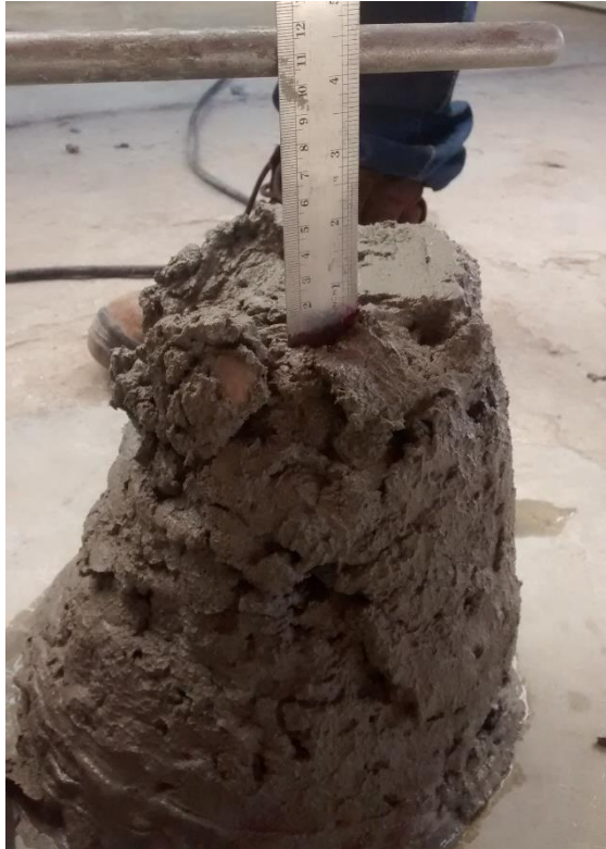
Figura 11 - Slump do concreto com 75% de substituição.
