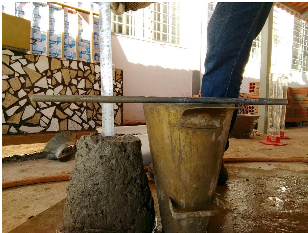
Figura 8 - Slump do concreto de referência.
