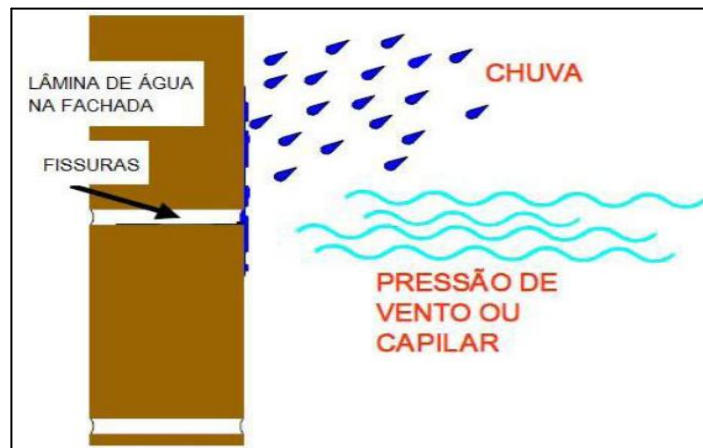
Figura 08: Infiltração da água da chuva.
