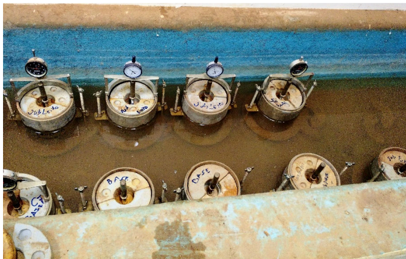
Figura 39 – Corpos de prova submersos por 96 horas
