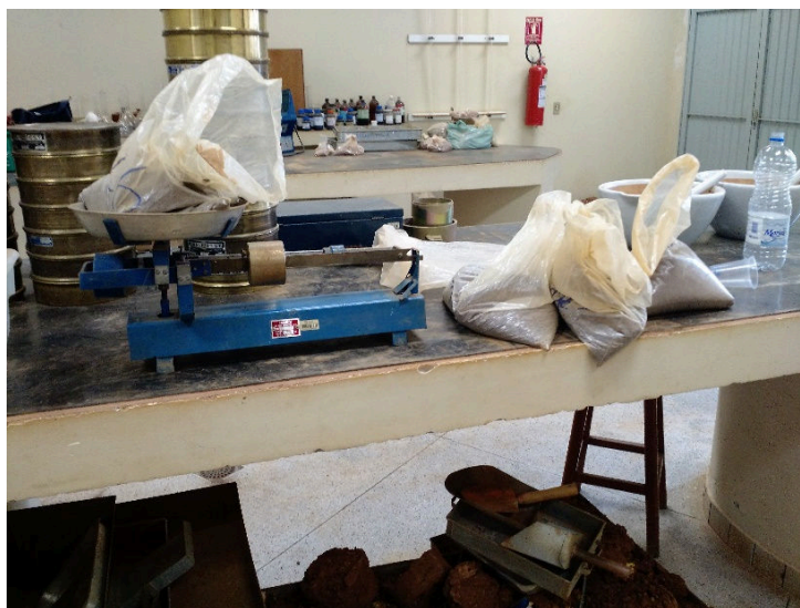
Figura 36 - Material separado em cinco corpos de prova contendo 5 kg cada
