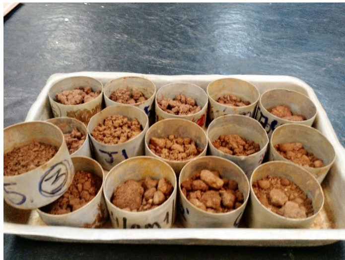
Figura 37 - Capsulas contendo material para ser realizado teste de umidade ótima
