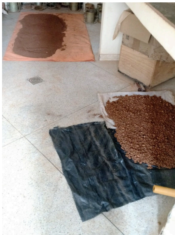
Figura 35 - Secagem do material já caracterizado
