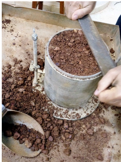
Figura 38 - Compactação do material de base no corpo de prova
