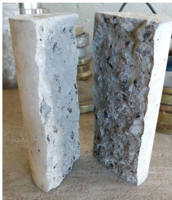
Figura 12 - Corpo de prova após ensaio de tração por compressão diametral
