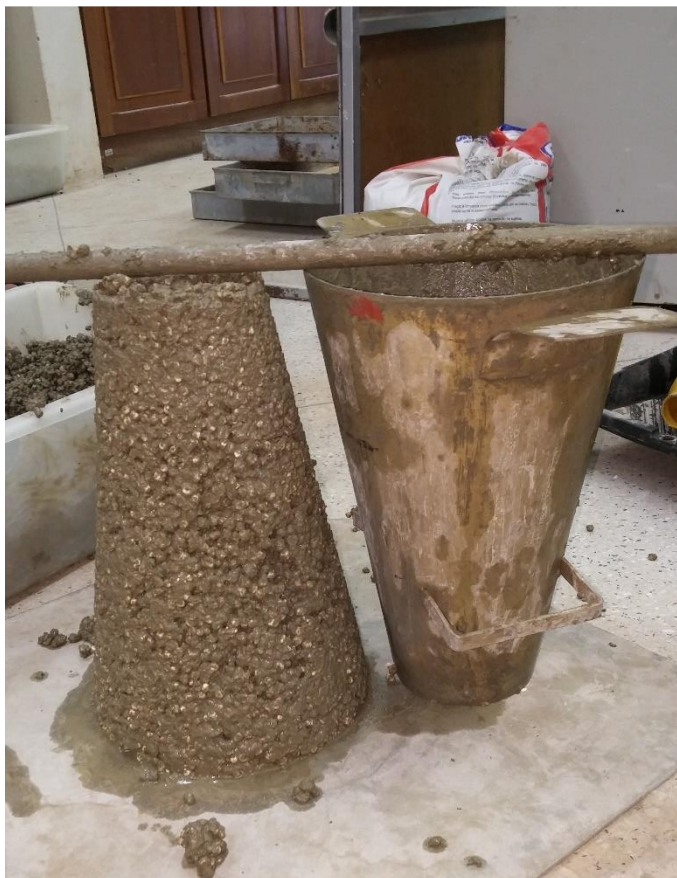
Figura 19: Consistência do concreto leve
