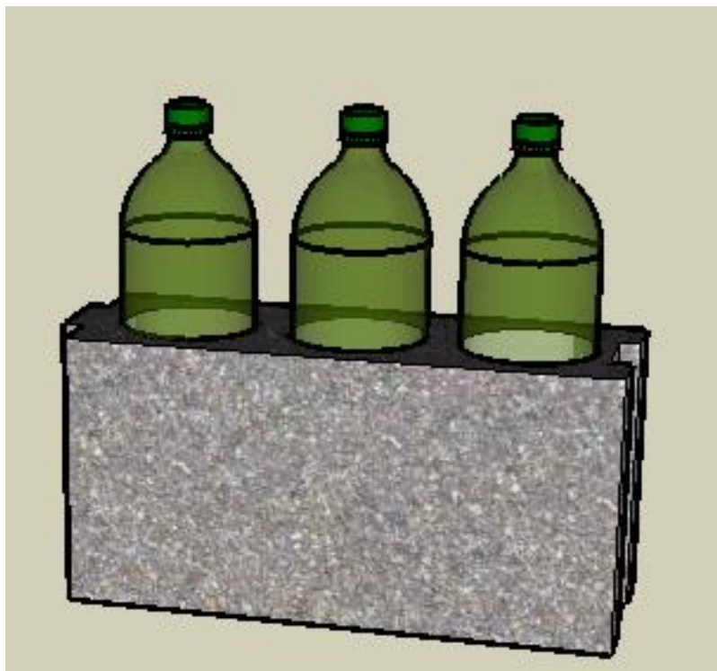
Figura 42: Corte Bloco Isopet
