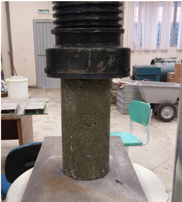
Figura 20: Corpo de prova sendo submetido à ensaio de compressão
