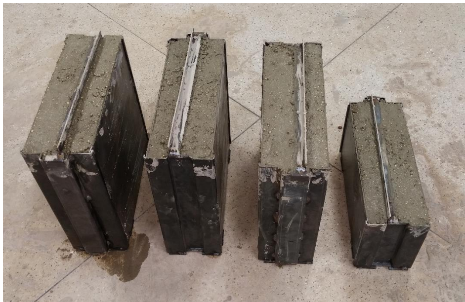
Figura 26: Blocos moldados nas fôrmas
