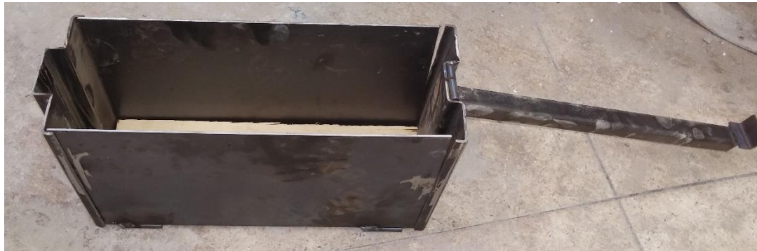
Figura 23: Fôrma de metal para fabricação dos blocos
