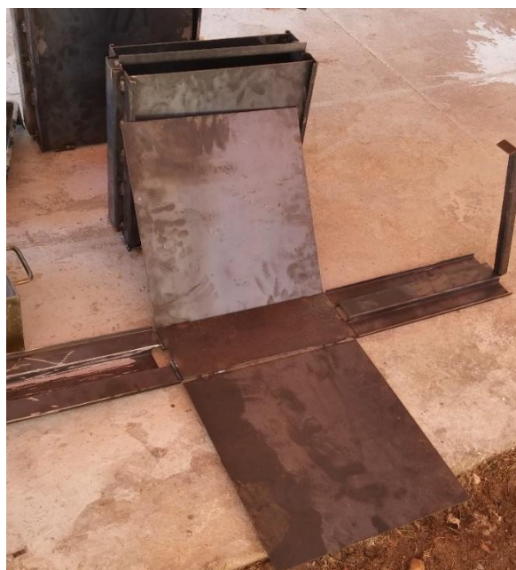
Figura 24: Fôrma para fabricação dos blocos
