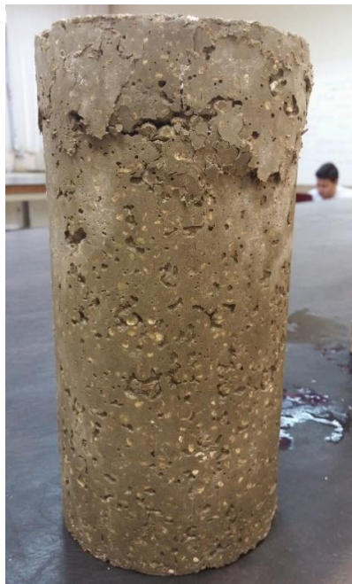
Figura 22: Corpo de prova após ensaio de compressão
