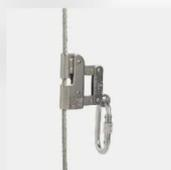
**CINTO TRAVA QUEDAS:** Para uso em cabo guia de aço galvanizado. Com dupla trava de segurança, permite movimentação livre na subida e descida, mantendo a função trava-queda.
