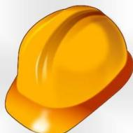
**CAPACETE:** Dispositivo básico de segurança em qualquer obra. O casco é feito de material plástico rígido, de alta resistência à penetração e impacto. Tem desenho para rebater o material em queda para o lado, evitando lesões no pescoço do trabalhador. É utilizado com suspensão, que permite o ajuste mais exato à cabeça e amortece os impactos.
